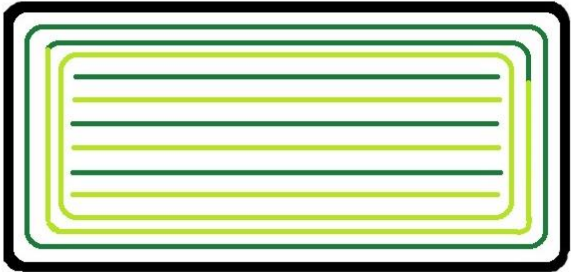
Kuva 8. Tapa, jolla lohko korjattiin puoliksi noukinvaunulla ja yhdistelmäpaalaimella.
