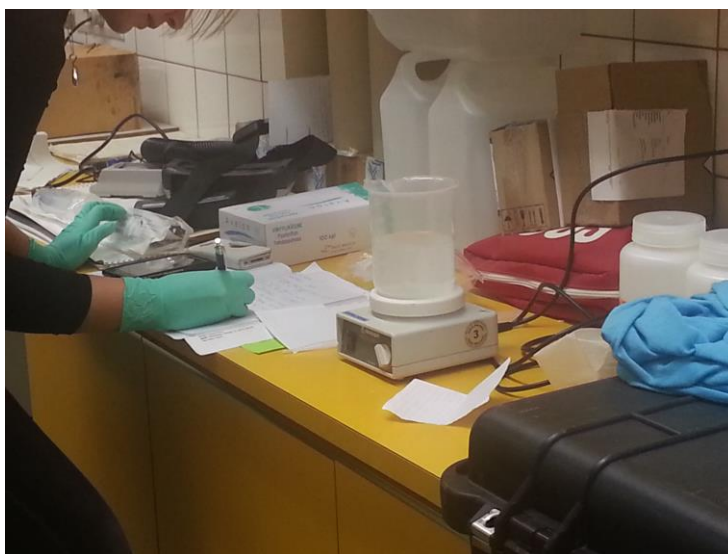
Kuva 3. Polymeeriliuoksen sekoitus kuppikokeita varten. Kullaanvuori lokakuu 2014
