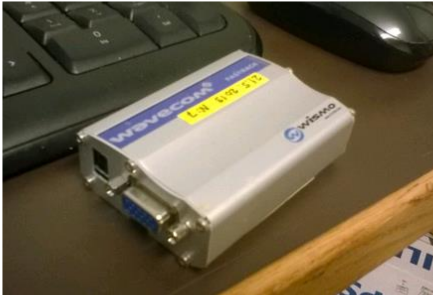
Kuvio 12. M1306B-modeemi edestä, virtalähteen ja Sub HD -portin osat näkyvissä
