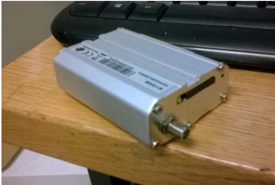
Kuvio 11. M1306B-modeemi takaa, antenni, ledi ja SIM-kortin paikka näkyvissä
