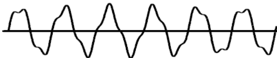
KUVA 2. Jännite, joka on säröytynyt epäharmonisen yliaallon vuoksi (ABB TTT-käsikirja, 2000b)
