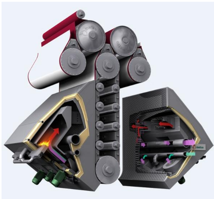
Kuvio 4. Päällepuhalluskuivaimen periaate (Valmet ProductVault 2015)
