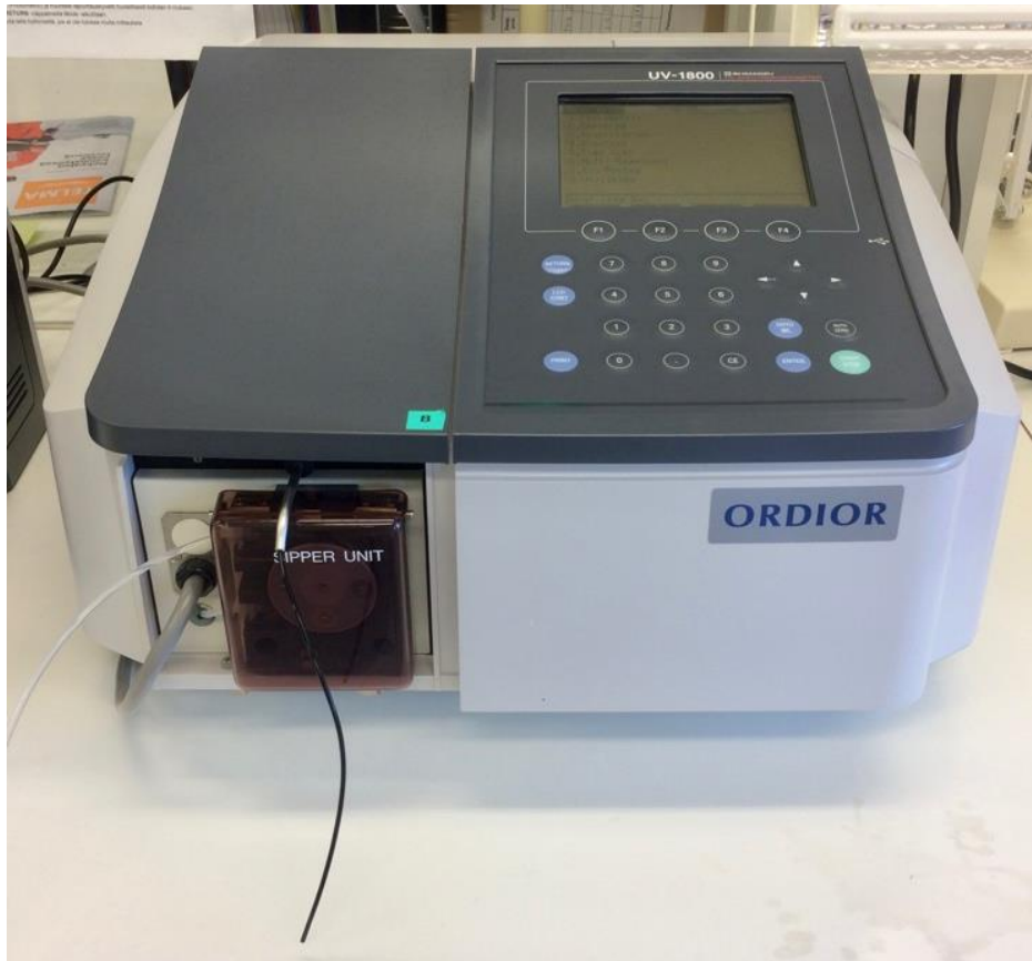
KUVA 1. Shimadzu UV-1800 -spektrofotometri ja läpivirtauspumppu (sipper unit) (Kuva: Sanna Lindström 2017)
