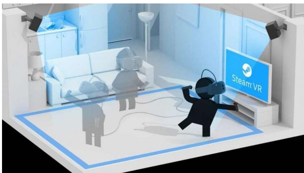
KUVA 1. HTC Vive sensorit – Sininen valo edustaa kuvan molemmissa yläkulmissa olevien sensorien havaitsemaa aluetta (Prasuethsut 2016)
