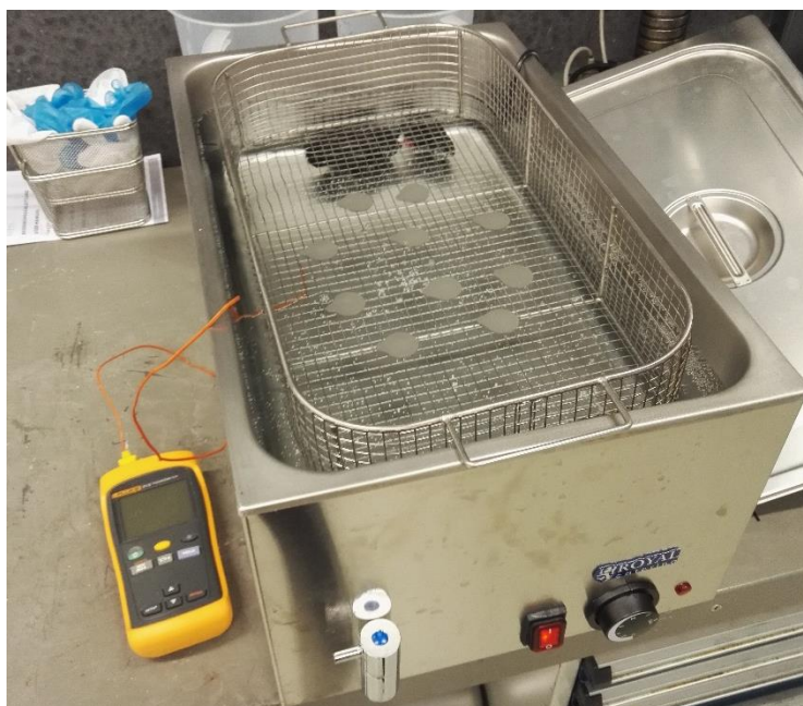
Kuvio 44. Sideaine poistettiin vesihauhteessa. Veden lämpötila oli noin 50 °C ja kappaleita pidettiin hauteessa seitsemän tuntia.
