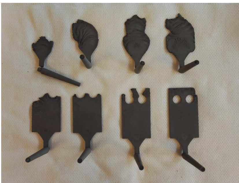
Kuvio 33. Täyttymissarja 4. Portin poikkipinta-ala oli suurempi kuin kanavan poikkipinta-ala.
