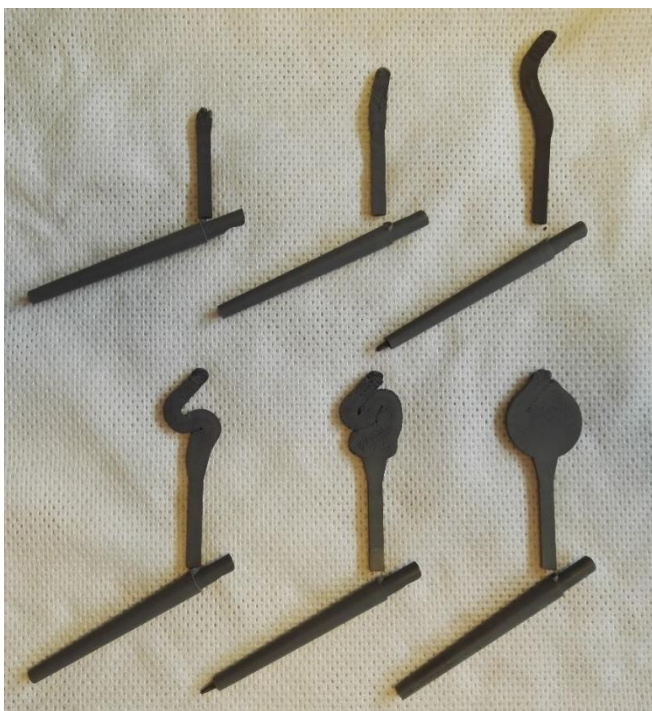
Kuvio 39. Testimuotin tuotteen täyttymissarjassa ilmeni selvä jetting-ilmio.
