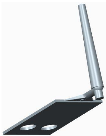
Kuvio 28. CAD-malli valetusta tuotteesta, jossa portin poikkipinta-ala oli suurempi kuin kanavan poikkipinta-ala.
