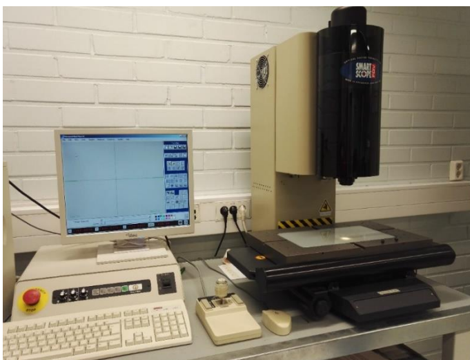
Kuvio 40. Halkaisijat ja ympyrämäisyys mitattiin videomittakoneelle.
