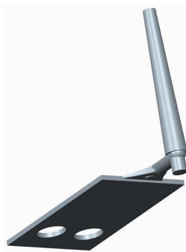
Kuvio 29. CAD-malli valetusta tuotteesta, jossa kanavan poikkipinta-ala oli yhtä suuri kuin portin suun poikkipinta-ala.
