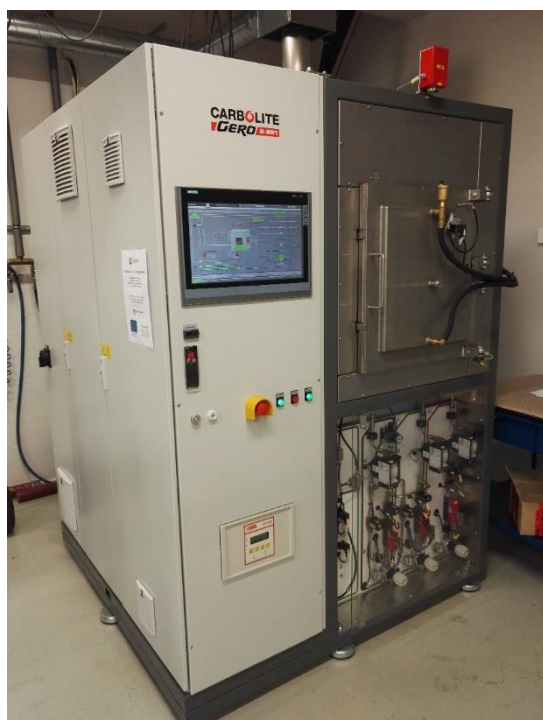
Kuvio 45. Sintrauksessa käytettiin Karelia-ammattikorkeakoulun sintrausuunia.
