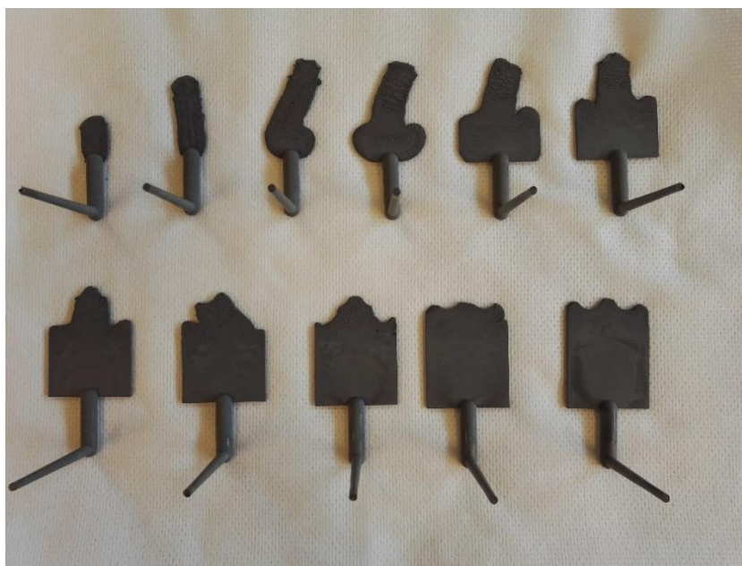
Kuvio 30. Täyttymissarja 1. Valukanavisto ja portti olivat kiinteällä puolella, jolloin sulavirtauma tuli pesän tasoon nähden kohtisuoraan.
