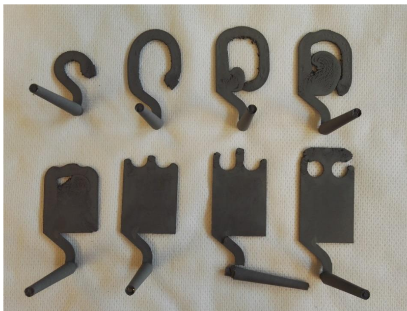
Kuvio 32. Täyttymissarja 3. Kanavisto ohjasi sulavirtauman pesän nurkkaan, missä se törmäsi sivuseinään ja lähti etenemään matona pesän reunoja myöten.
