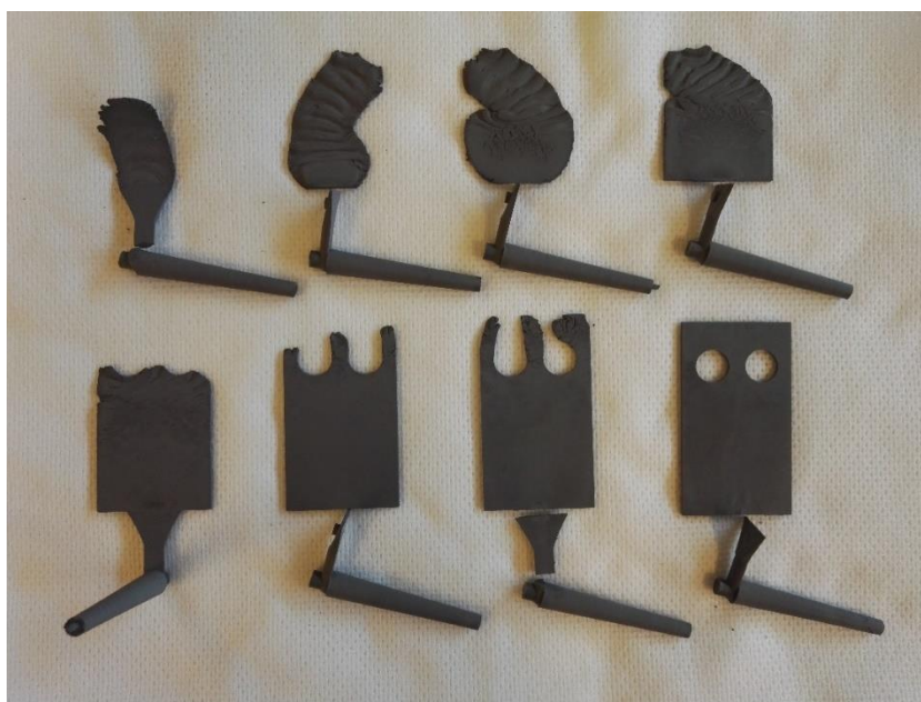
Kuvio 34. Täyttymissarja 5. Portin poikkipinta-ala oli yhtä suuri kuin kanaviston poikkipinta-ala.
