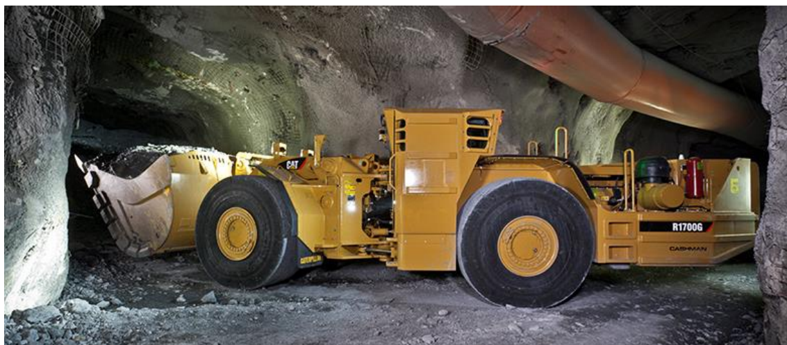
Kuvio 10. Maanalaisiin kaivoksiin kehitetty LHD (load-haul-dump) –lastauskone (Ottawa 2013)
