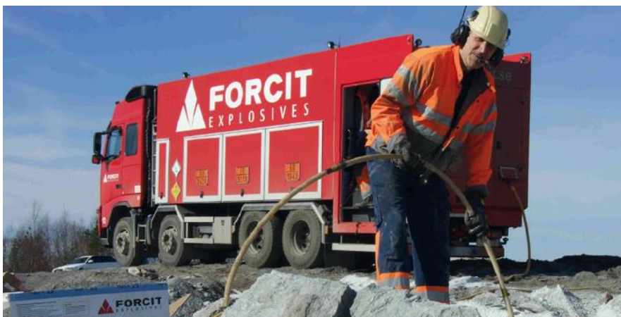
Kuvio 7. Esimerkkikuva avolouhoksilla käytettävästä emulsioräjäytysaineiden panostusajoneuvosta. (Halonen 2016, 6)
