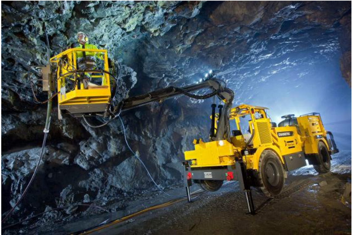
Kuvio 6. Kaivoksilla, tunnelityömailla ja suurilla louhintatyömailla käytettävä AN-FO-panostusajoneuvo (Tunneltalk 2012)
