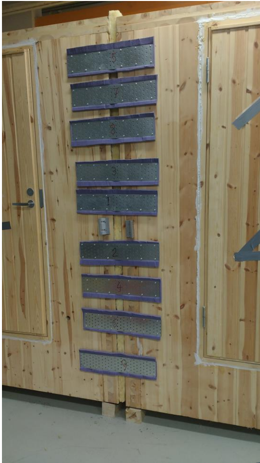
Kuva 10. Väliseinän ääneneristävyyden mittaus. 18 kiinnikelevyä kiinnitettynä elementtien välille.
