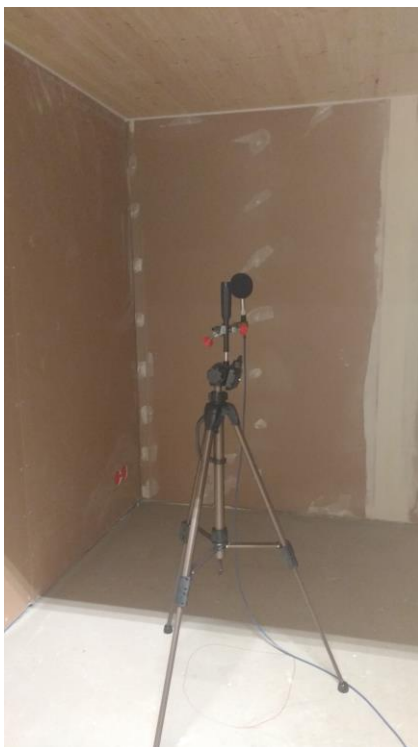
Kuva 6. Mikrofoni paikoillaan vastaanottavassa tilaelementissä.
