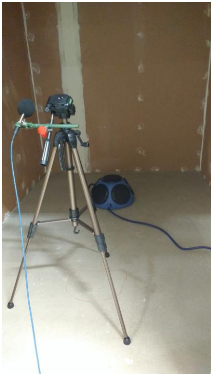
Kuva 4. Lähettävän tilan äänenpainetason mittaus.
