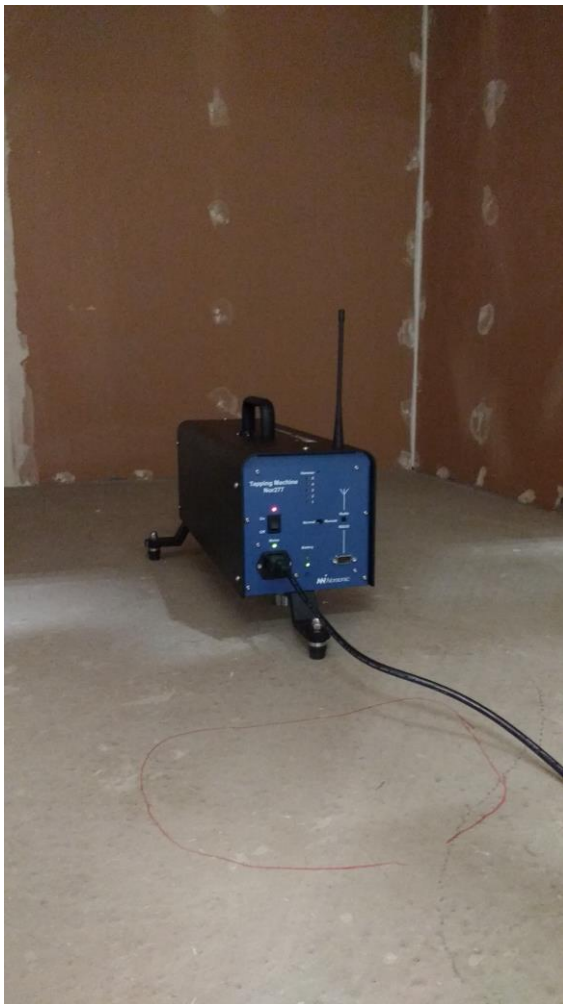
Kuva 8. Mittauksissa käytetty askeläänikoje, joka asetettiin mittaustilanteessa 45 asteen kulmaan huoneen seiniin nähden.
