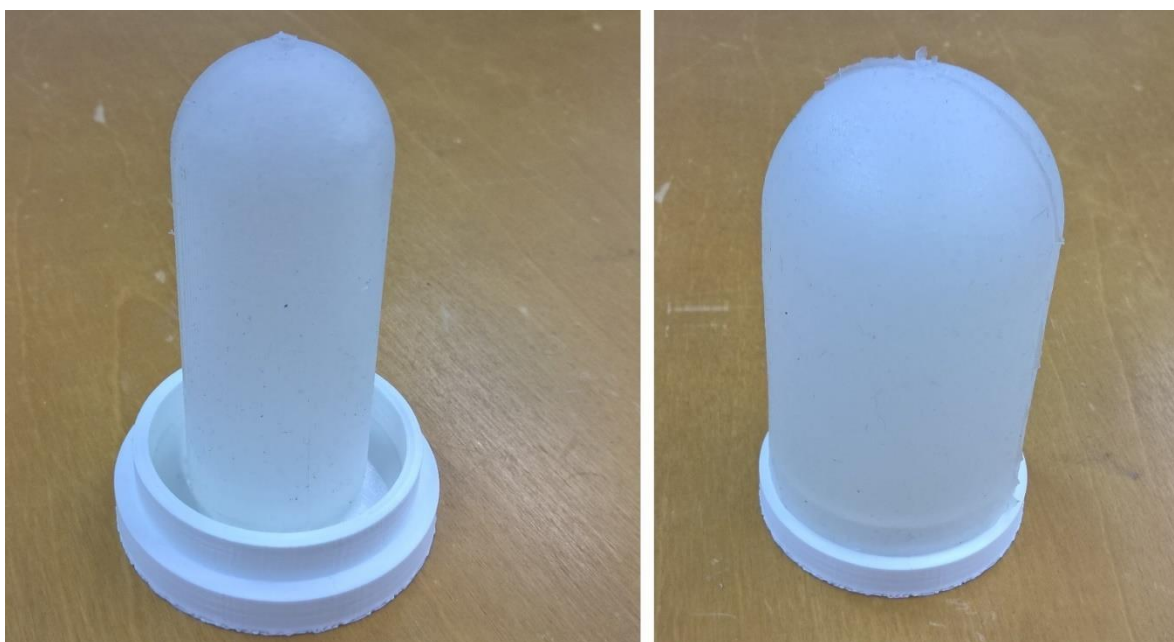
Kuva 24. Phantomin sisempi ja ulompi osa asetettuna alustaan (Aartonen, 2017)
