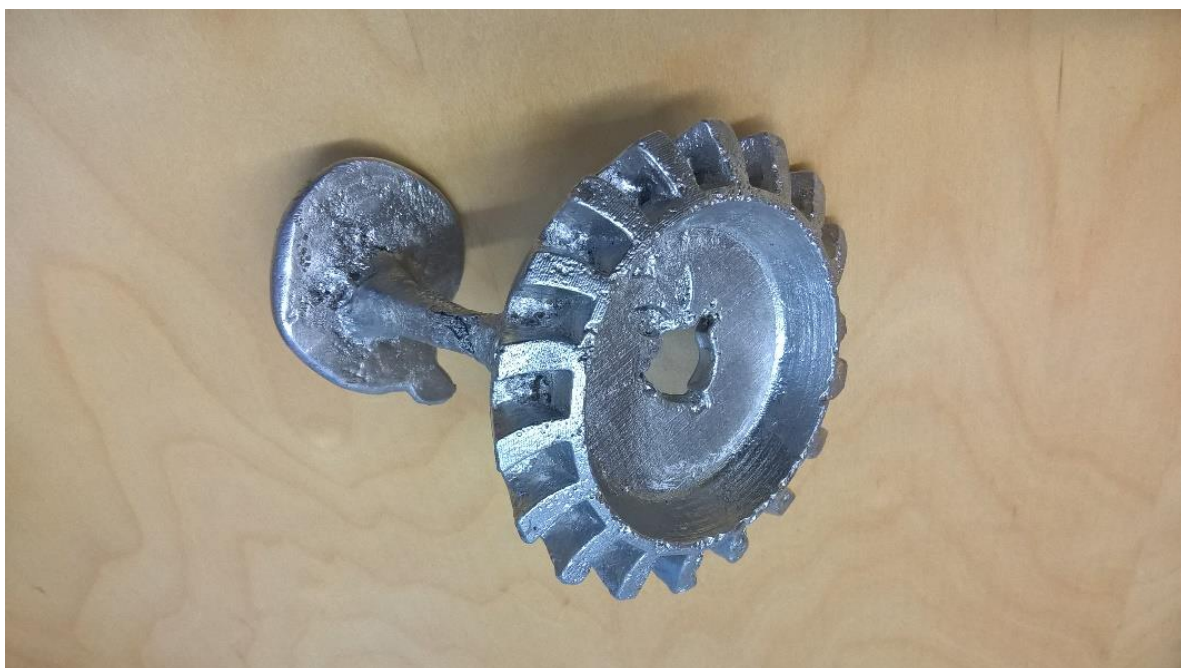
Kuva 9. Toinen hiekkavalettu kappale (Aartonen,2017)
