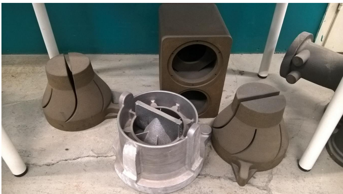
Kuva 4. Hetitec Oy:n hiekasta tulostettuja kaiuttimen osia ja kotelo (Aartonen, 2017)
