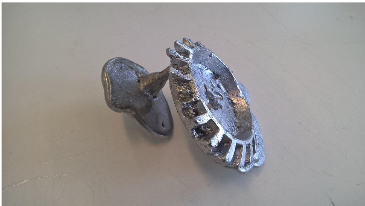
Kuva 8. Ensimmäinen hiekkavalettu kappale (Aartonen, 2017)
