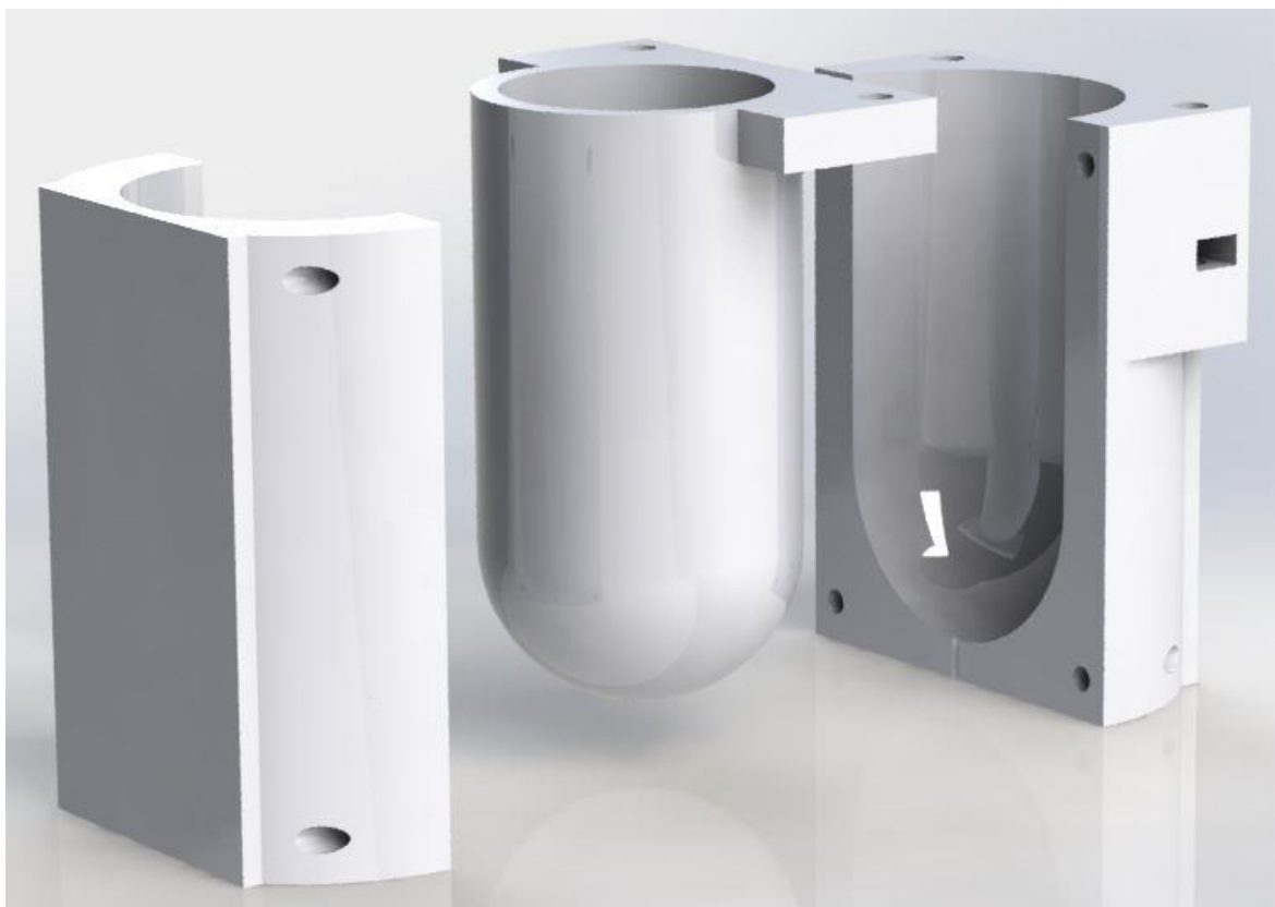
Kuva 20. Ulomman kuoren muotin 3D-mallit (Aartonen, 2017)
