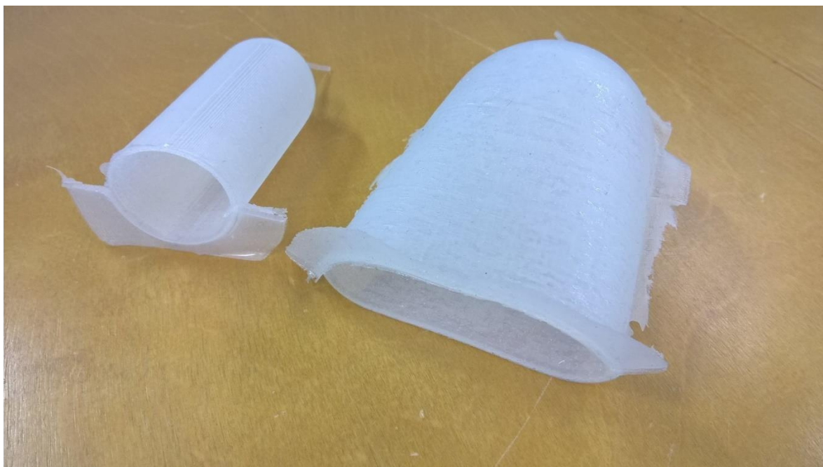
Kuva 23. Phantomin ulompi ja sisempi osa silikonista valettuna (Aartonen, 2017)
