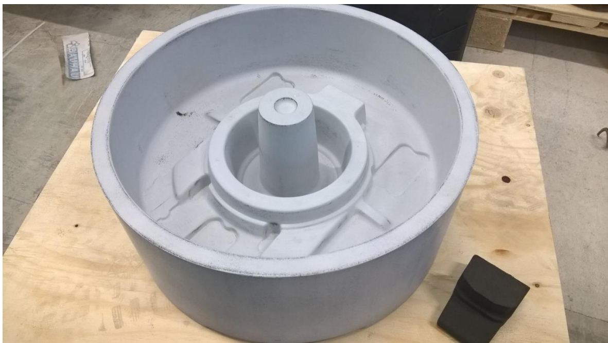
Kuva 5. Hiekasta tulostettu ja pinnoitettu valumalli (Aartonen, 2017)
