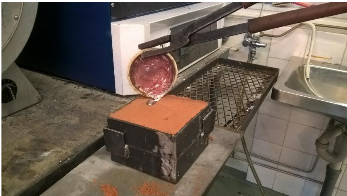
Kuva 6. Sulan kaatoa muottiin (Aartonen, 2017)
