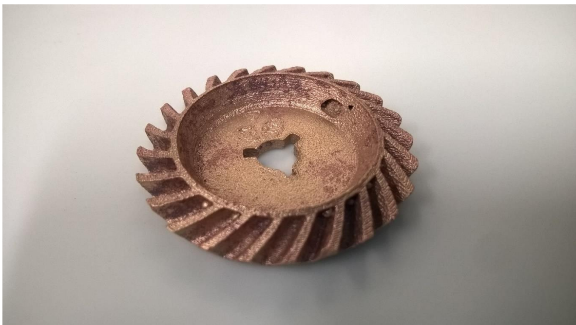
Kuva 18. Pronssista valettu hammaspyörä (Aartonen, 2017)
