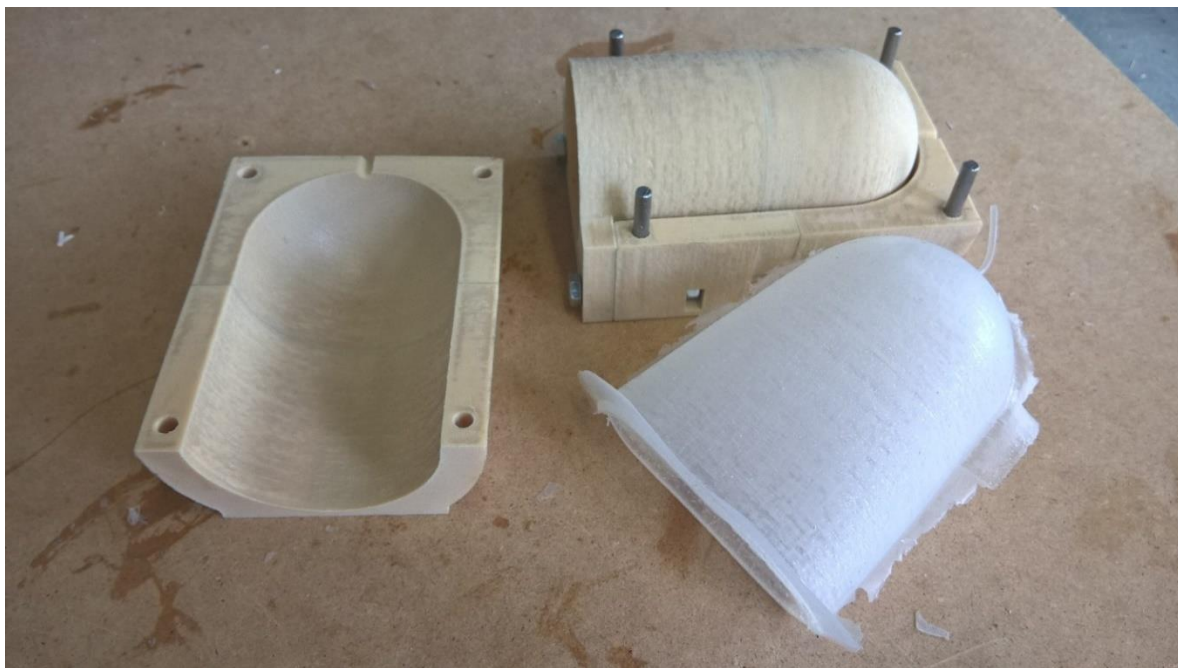
Kuva 22. Silikonista valettu kappale ja muotit (Aartonen, 2017)
