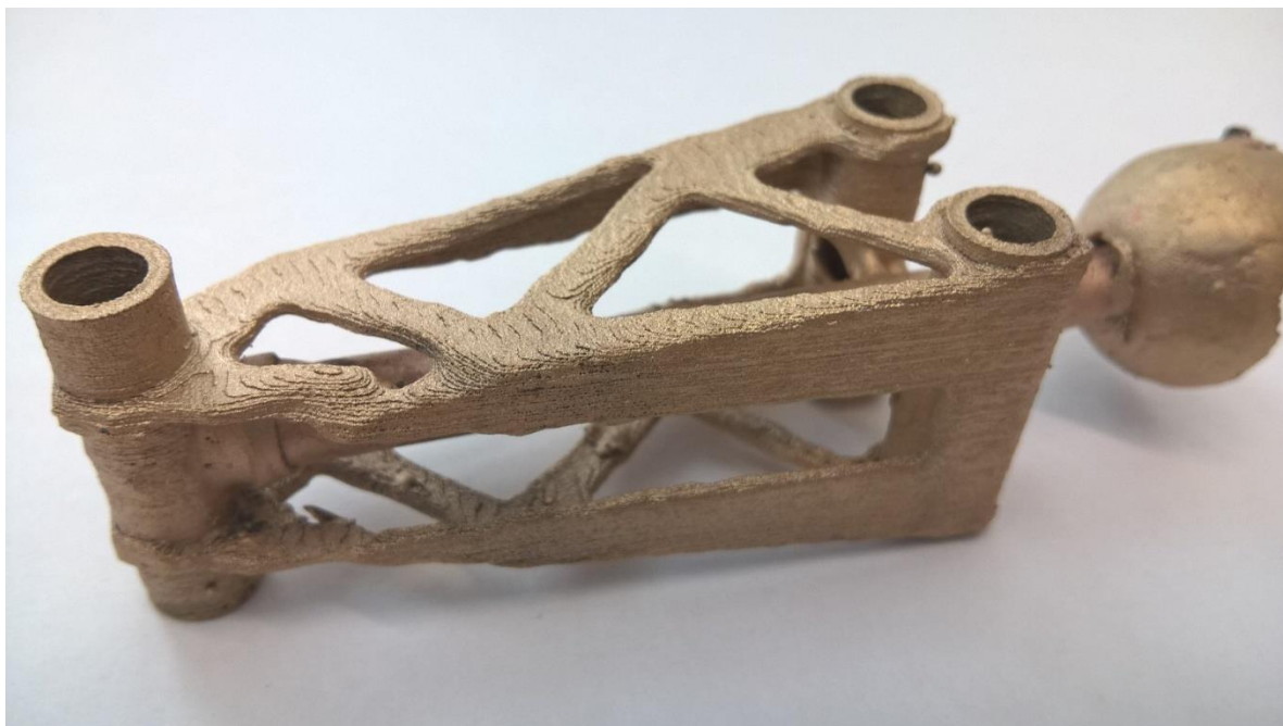
Kuva 15. Pronssinen tarkkuusvalettu kappale valukanava paikoillaan (Aartonen, 2017)
