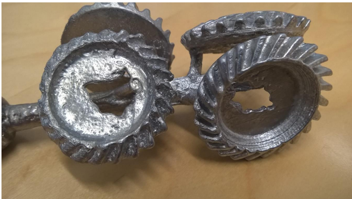
Kuva 17. Tarkkuusvaletut hammaspyörät kiinni valupuussa. Vasemmalla Polyamidi-12, oikealla PLA (Aartonen, 2017)
