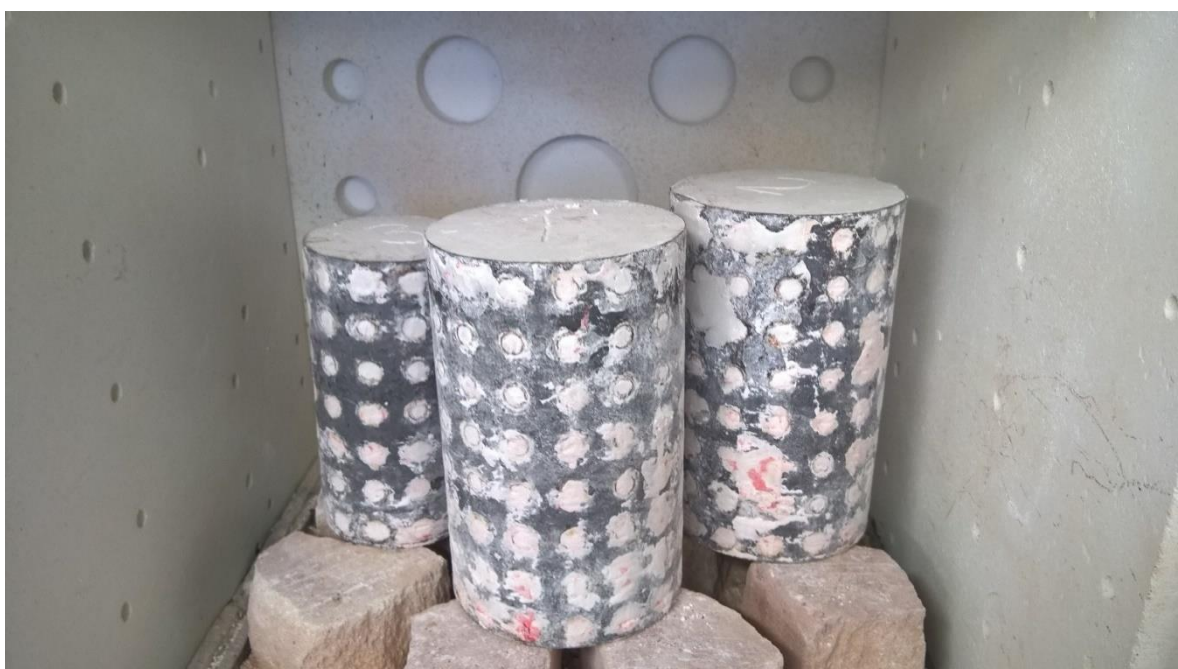
Kuva 14. Kaikki kolme muottia uunissa ennen lämmitysvaihetta (Aartonen, 2017)
