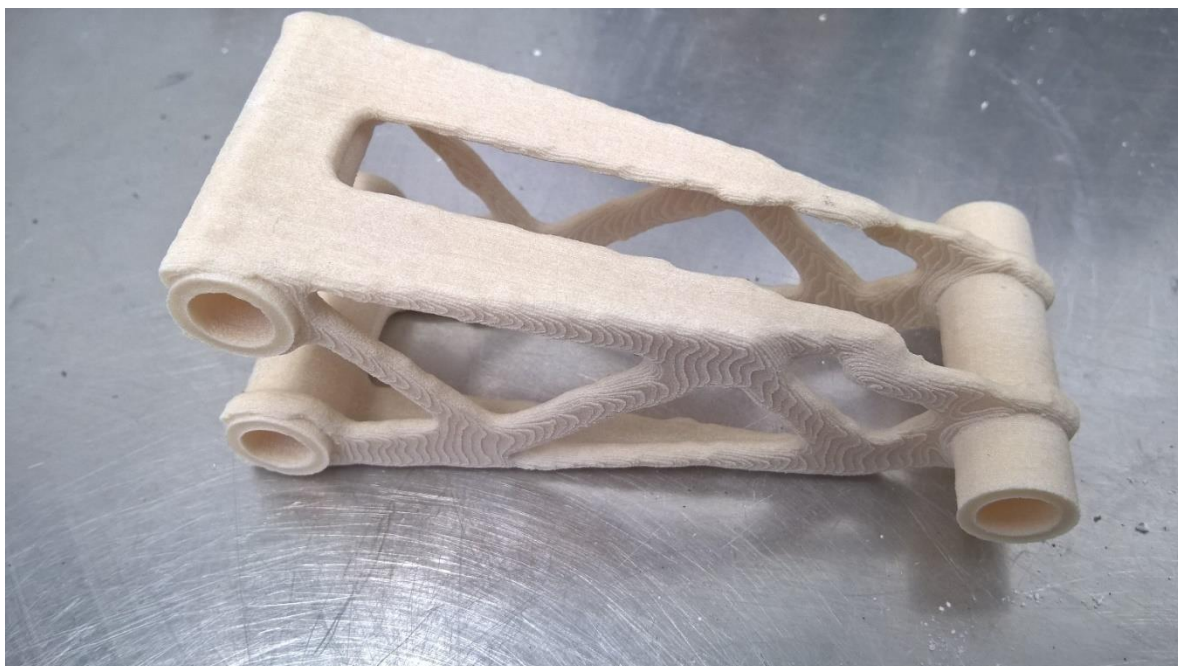
Kuva 11. Topologisesti optimoitu kiinnike, jonka materiaalina oli PA12. Kappaleen pituus on noin 120 mm (Aartonen, 2017)
