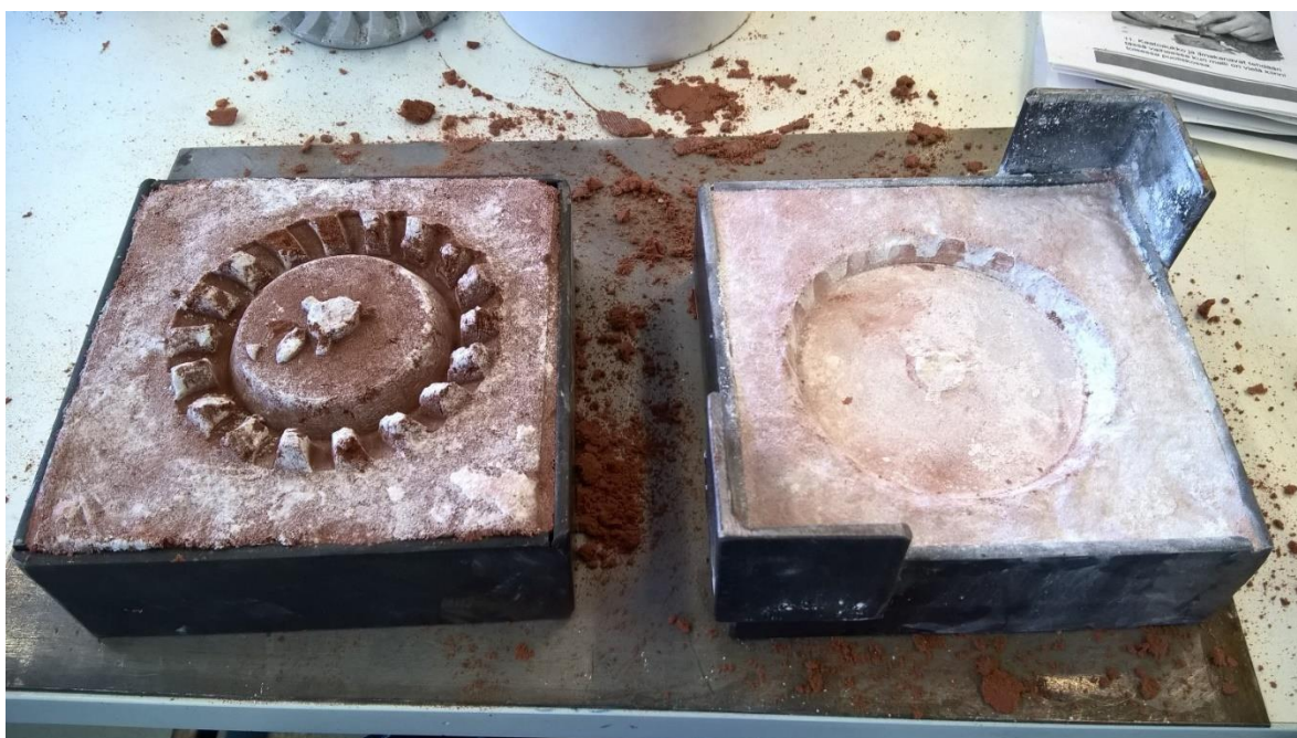
Kuva 2. Hiekkamuotit ja kappaleen negatiivipinnat kaavauskehyksissään (Aartonen, 2017)
