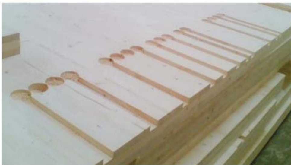
KUVA 4. CNC -koneella jyrsittyjä sähkökaapeliuria CLT – elementissä (Puuinfo.fi k.)
