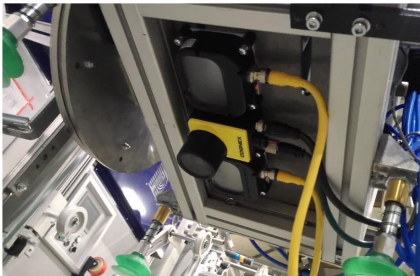
KUVA 7. Tarttujan pohjaan kiinnitetty konenäkökamera, sekä sen viereen asennetut teho LED-valot
