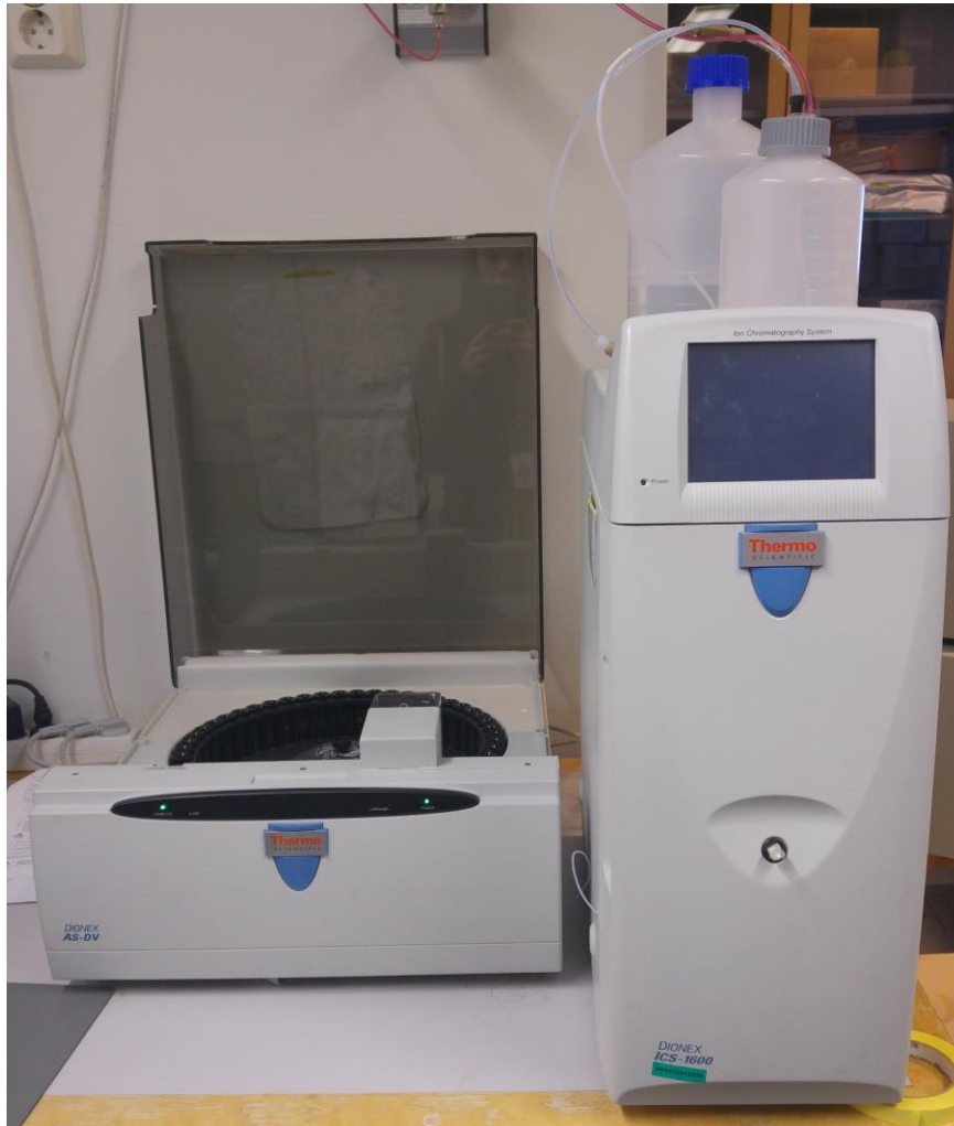
KUVA 2. Sulfaattipitoisuuksien seurannassa käytetty ionikromatografi (Kuva: Linda Parkkinen 2017)
