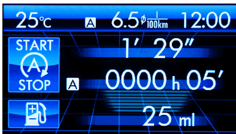
Kuva 3. Sammutusautomaatti auton ajotietokoneessa (Subaru 2012).
