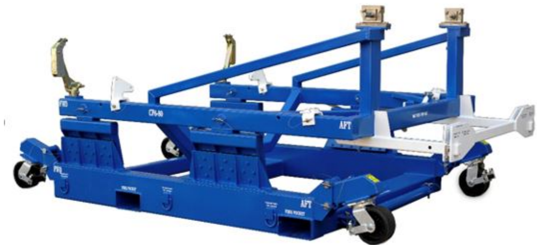
Kuvio 6. DAE Industriesin valmistama kuljetusteline General Electric CF6-80-moottoreille (DAE Industries n.d.)
