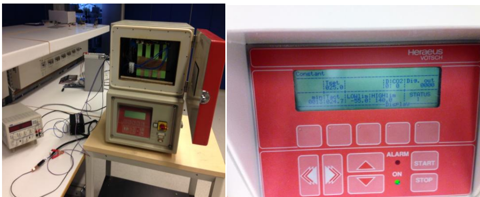
Kuva 19. LiFeP04 lämpötilan testikammioon asetettuna ja kammion näytön näkymä käynnistyksen jälkeen.
