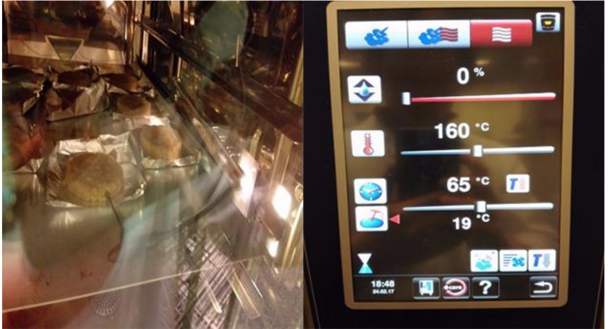
Kuva 21. Kiertoilmauunin asetukset sekä lämpömittarin asettelu.
