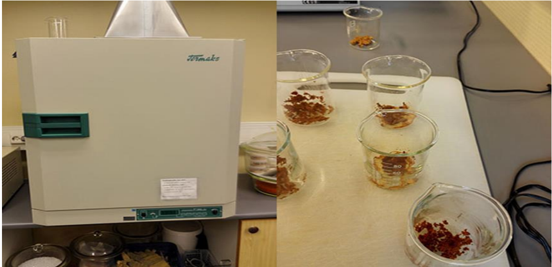
Kuva 3. Kuiva-ainemittauslaitteisto ja kuivatut näytteet.
