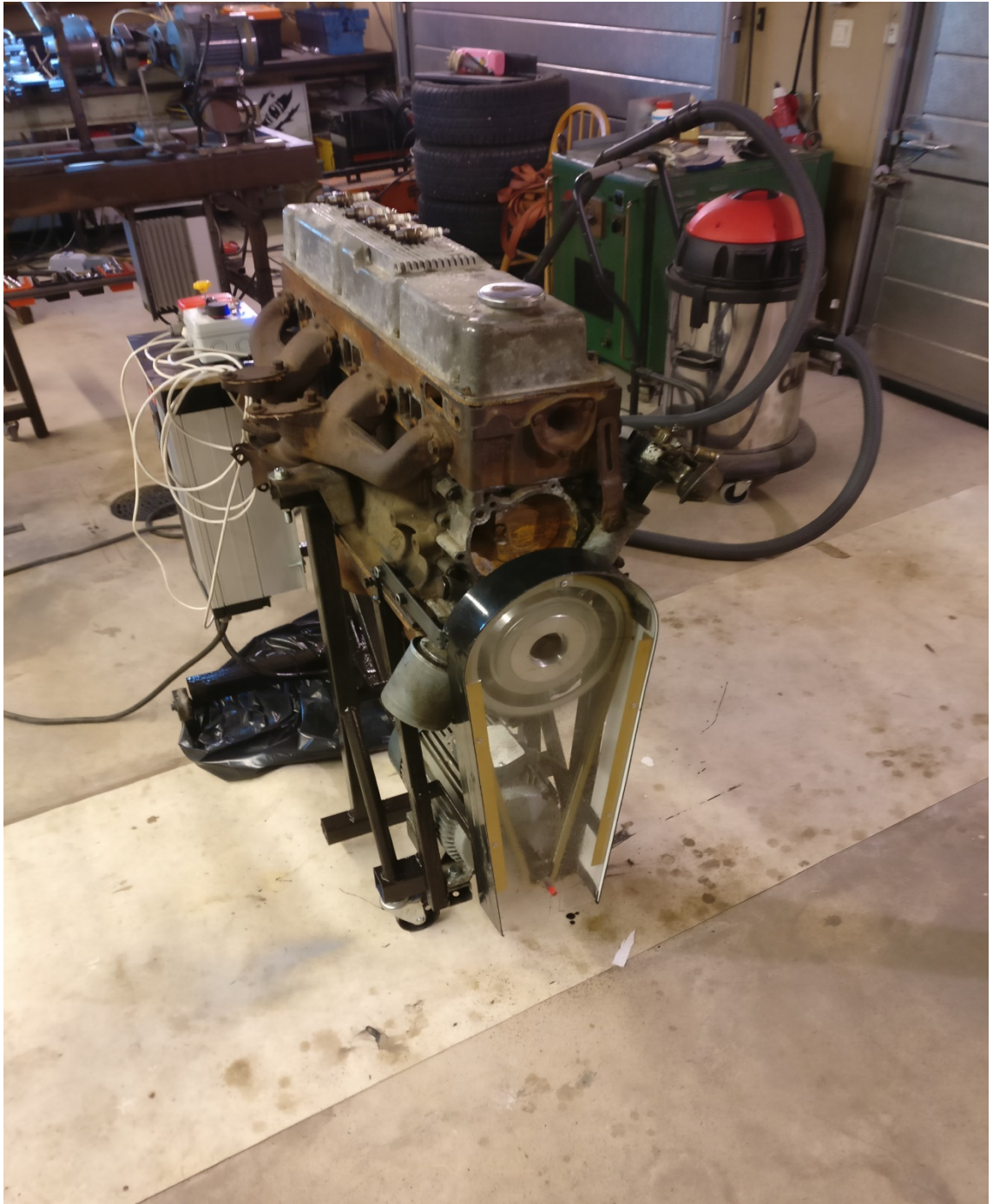
Kuva 8. Turvallisuussyistä ketjuveto on suojattu
