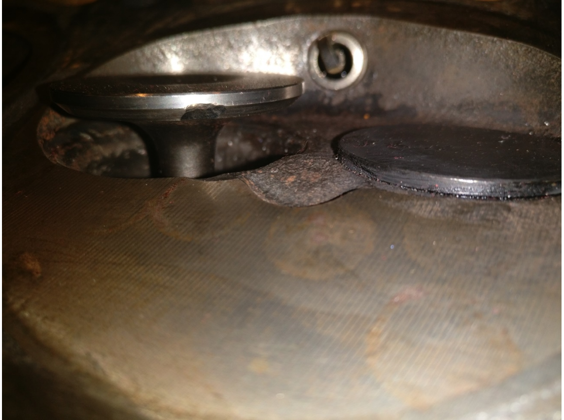
Kuva 5. Venttiilin tiivistyspinta vaurioitettuna
