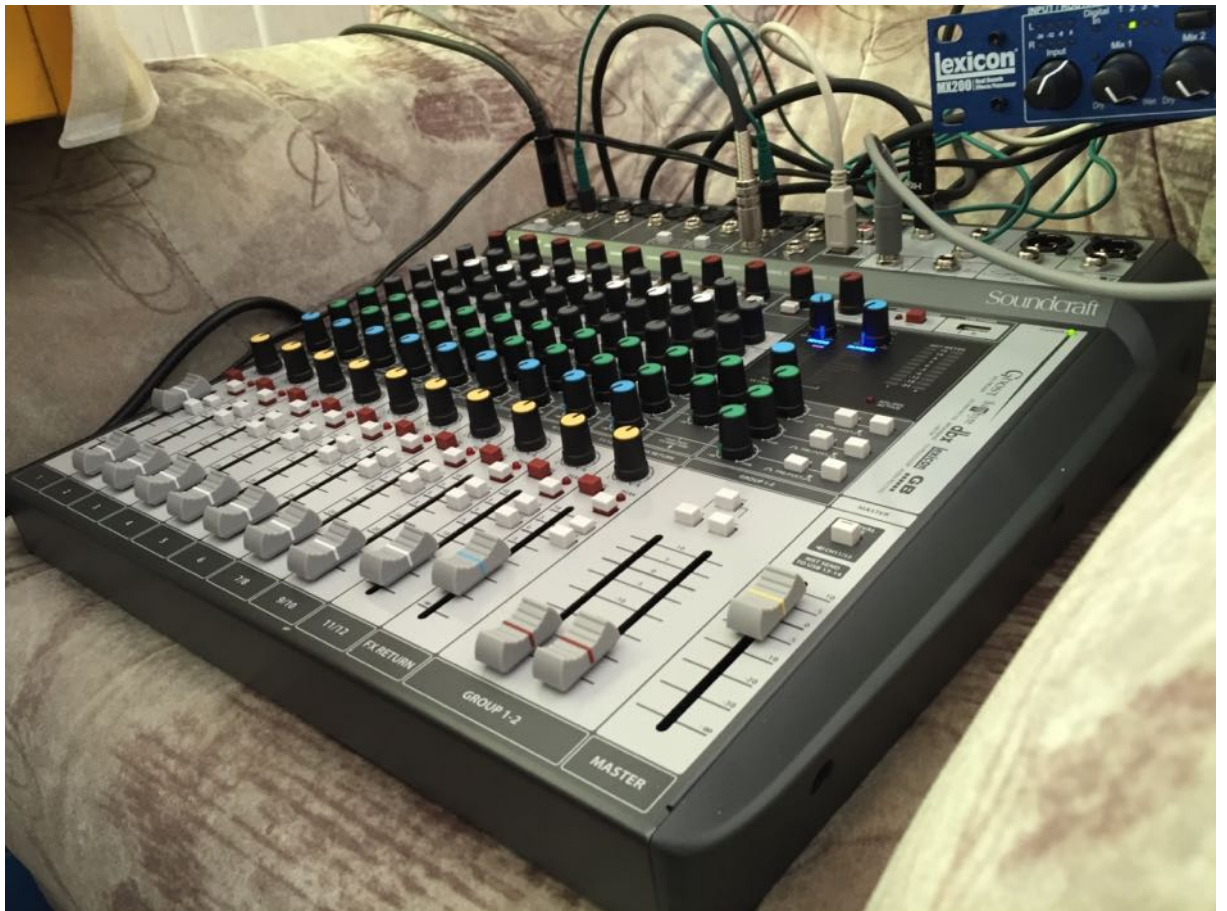
Kuvio 8. Soundcraft Signature 12 MTK on analoginen mikseri, jonka kaikille kanavalohkoille voi ohjata audiota myös tietokoneen DAW –ohjelmasta analogista miksausta varten. Kuva Christer Jokela 2016.
