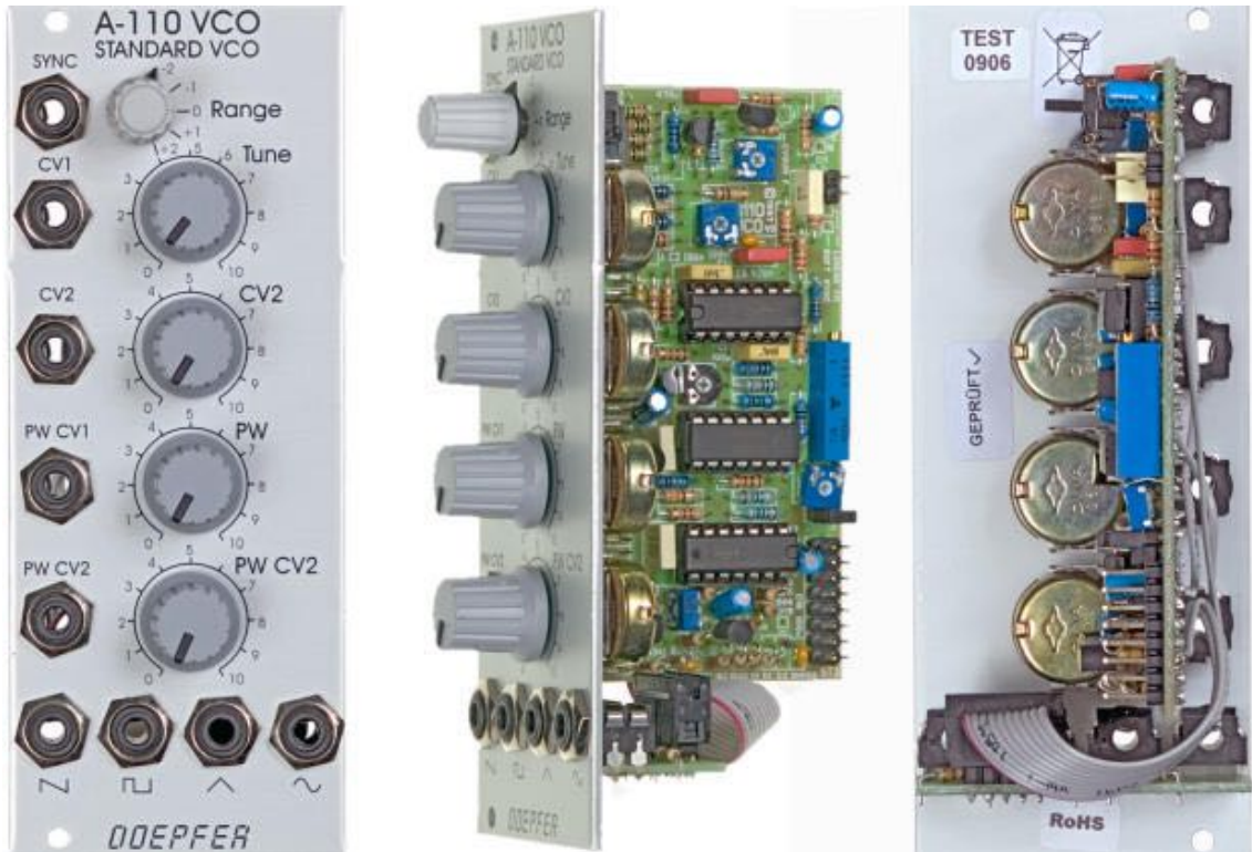
Kuvio 1. Kuvassa Doepfer –valmistajan oskillaattorimoduuli, joka on kuvattuna edestä, sivusta ja takaa. Se on moduuli, joka voidaan laittaa modulaariseen syntetisaattoriin. Paikoilleen asennettuna moduulista näkyy sen etupaneeli, joka on kuvassa vasemmalla. Piirilevy, kuvassa keskellä, yhdistetään virtalähteeseen. Piirilevy ja virtalähde ovat moduuleille tarkoitetun kotelon sisällä.
