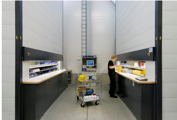
Kuva 2. Paternosterit eli vertikaalikarusellit ovat tarkoitettu pientavaran keräilyyn. Käsittelyaukko on ergonomisella korkeudella, jonka takia ei tarvitse kurkotella ylöspäin tai nostaa lattiatasosta. (Constructor Finland Oy n.d.)
