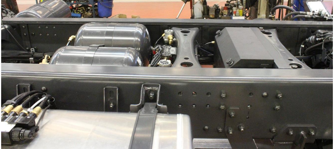
Kuvio 9. Ilmasäiliöiden ja asennetun hydraulikkapumpun paikka.
