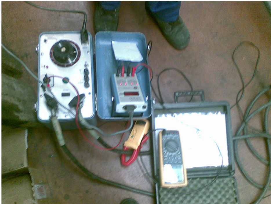
Kuva 14. Virtalähde, aikamittari, pihtiampeerimittari ja mittajohtoja
