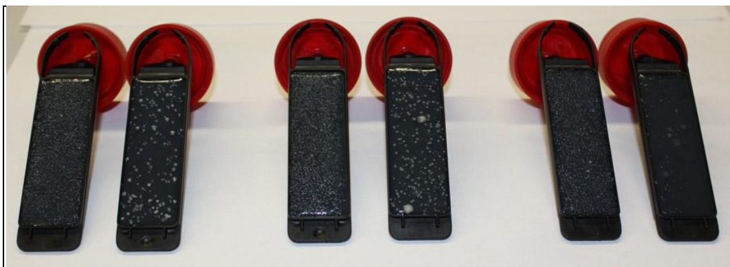
Kuvio 25: Bambuhamppuneuloksen bakteerikartoitusnäytteet neljännen pesun jälkeen, testilevyjen ensimmäiset puolet (järjestys vasemmalta: Erisan 40°, Erisan 60°, Softcare 40°, Softcare 60°, LV 40°, LV 60°)
