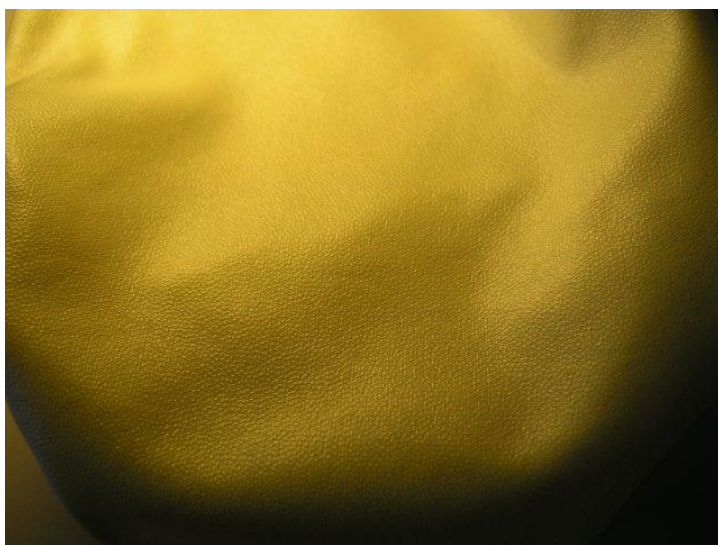
Kuvio 33: Laminointi nestemäisellä pesuaineella pestynä kolmannen pesun jälkeen
