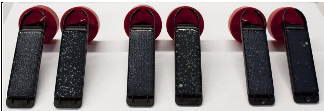
Kuvio 19: Bambupuuuwillapolyesterineuloksen bakteerikartoitusnäytteet neljänsien pesun jälkeen, testilevyjen ensimmäiset puolet (järjestys vasemmalta: Erisan 40°, Erisan 60°, Softcare 40°, Softcare 60°, LV 40°, LV 60°)
