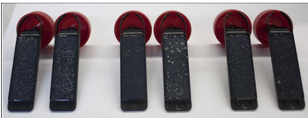
Kuvio 21: Bambupuuvillapolyesterineuloksen bakteerikartoitusnäytteet kahdeksannen pesun jälkeen, testilevyjen ensimmäiset puolet (järjestys vasemmalta: Erisan 40°, Erisan 60°, Softcare 40°, Softcare 60°, LV 40°, LV 60°)
