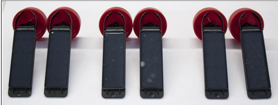
Kuvio 24: Bambupuuvillapolyesterineuloksen bakteerikartoitusnäytteet 90 celsiusasteen pesun jälkeen, testilevyjen toiset puolet (järjestys vasemmalta: Erisan 40°, Erisan 60°, Softcare 40°, Softcare 60°, LV 40°, LV 60°)
