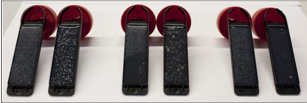
Kuvio 20: Bambupuuvillapolyesterineuloksen bakteerikartoitusnäytteet neljännen pesun jälkeen, testilevyjen toiset puolet (järjestys vasemmalta: Erisan 40°, Erisan 60°, Softcare 40°, Softcare 60°, LV 40°, LV 60°)
