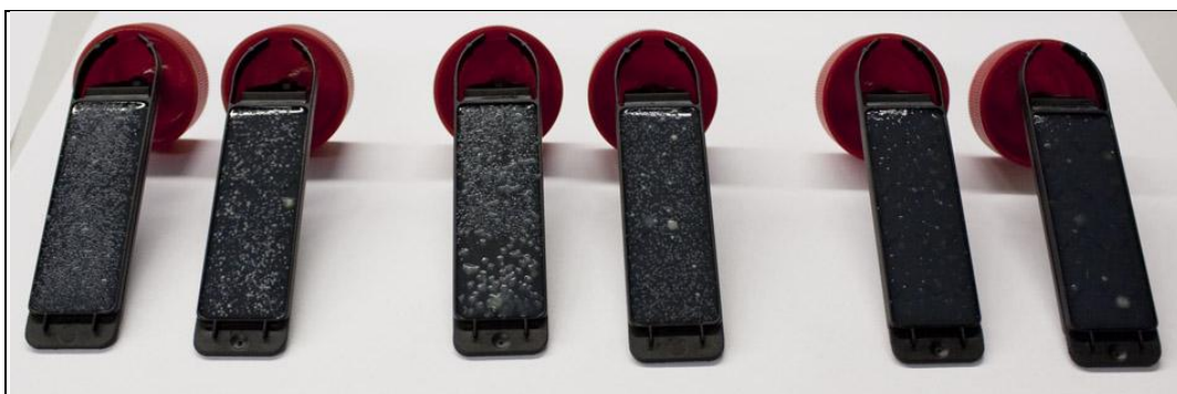
Kuvio 13: Bambupuuuwillaneuloksen bakteerikartoitusnäytteet neljännen pesun jälkeen, testilevyjen ensimmäiset puolet (järjestys vasemmalta: Erisan 40°, Erisan 60°, Softcare 40°, Softcare 60°, LV 40°, LV 60°)
