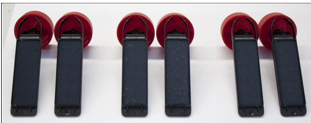
Kuvio 23: Bambupuuvillapolyesterineuloksen bakteerikartoitusnäytteet 90 celsiusasteen pesun jälkeen, testilevyjen ensimmäiset puolet (järjestys vasemmalta: Erisan 40°, Erisan 60°, Softcare 40°, Softcare 60°, LV 40°, LV 60°)
