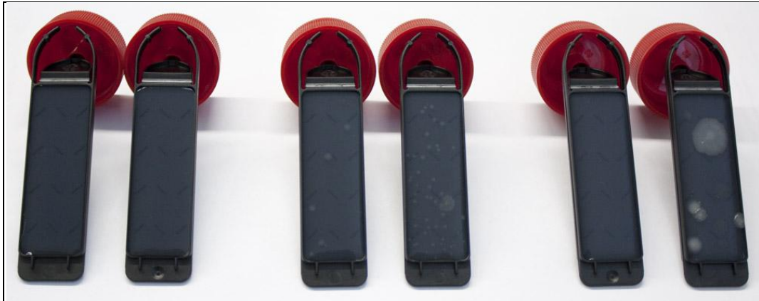
Kuvio 18: Bambupuuvillaneuloksen bakteerikartoitusnäytteet 90 celsiusasteen pesun jälkeen, testilevyjen toiset puolet (järjestys vasemmalta: Erisan 40°, Erisan 60°, Softcare 40°, Softcare 60°, LV 40°, LV 60°)
