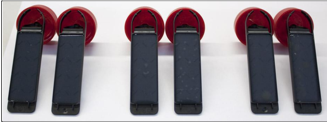
Kuvio 30: Bambuhamppuneuloksen bakteerikartoitusnäytteet 90 celsiusasteen pesun jälkeen, testilevyjen toiset puolet (järjestys vasemmalta: Erisan 40°, Erisan 60°, Softcare 40°, Softcare 60°, LV 40°, LV 60°)
