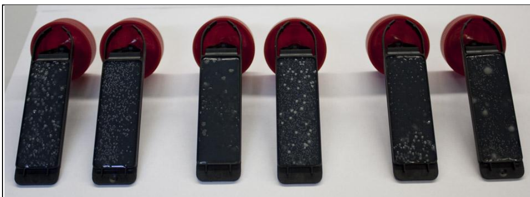
Kuvio 15: Bambupuuvillaneuloksen bakteerikartoitusnäytteet kahdeksannen pesun jälkeen, testilevyjen ensimmäiset puolet (järjestys vasemmalta: Erisan 40°, Erisan 60°, Softcare 40°, Softcare 60°, LV 40°, LV 60°)
