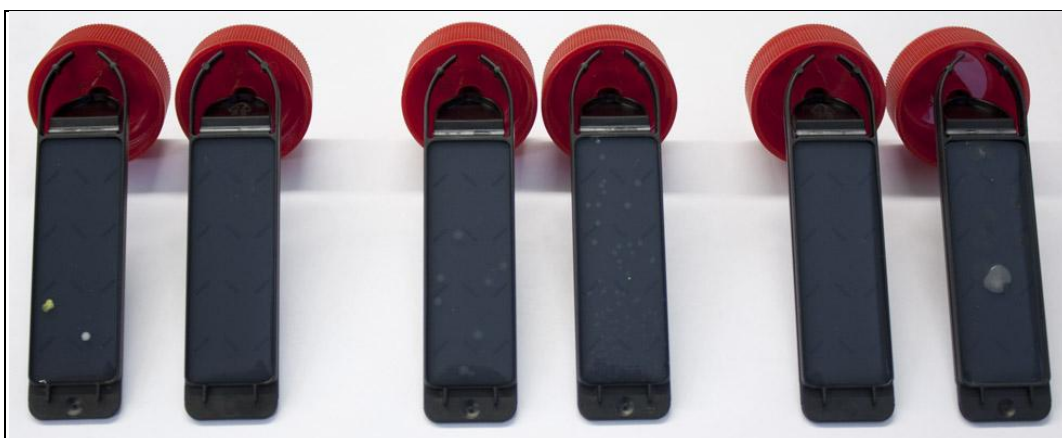
Kuvio 17: Bambupuu villaneuloksen bakteerikartoitusnäytteet 90 celsiusasteen pesun jälkeen, testilevyjen ensimmäiset puolet (järjestys vasemmalta: Erisan 40°, Erisan 60°, Softcare 40°, Softcare 60°, LV 40°, LV 60°)
