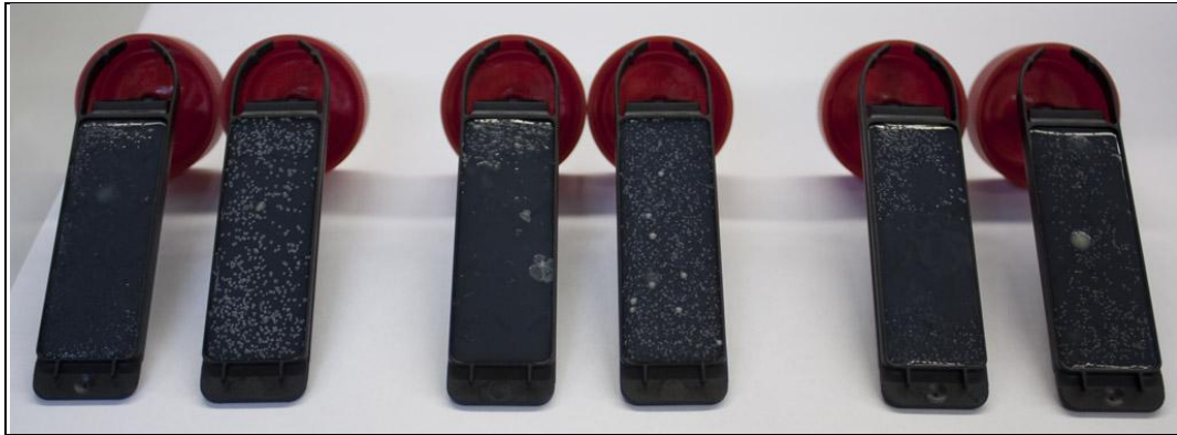
Kuvio 28: Bambuhampuneuloksen bakteerikartoitusnäytteet kahdeksannen pesun jälkeen, testilevyjen toiset puolet (järjestys vasemmalta: Erisan 40°, Erisan 60°, Softcare 40°, Softcare 60°, LV 40°, LV 60°)
