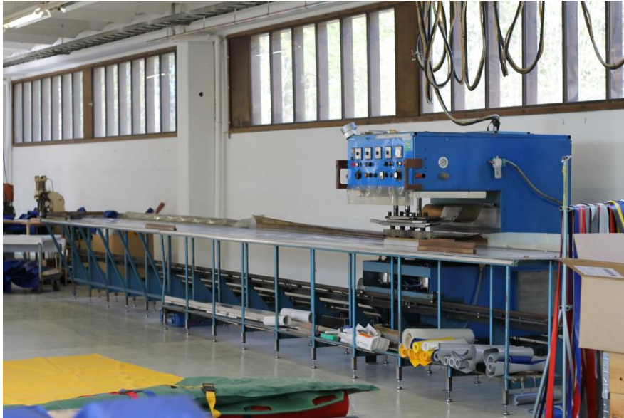
Kuva 4. Fiab-suurjaksosaumauskone, jonka pituus on 9,5 m.
