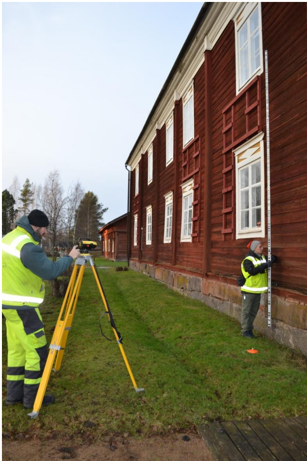
Kuva 10 Kivijalan seurantapisteitä mitataan paikoilleen joulukuussa 2014
