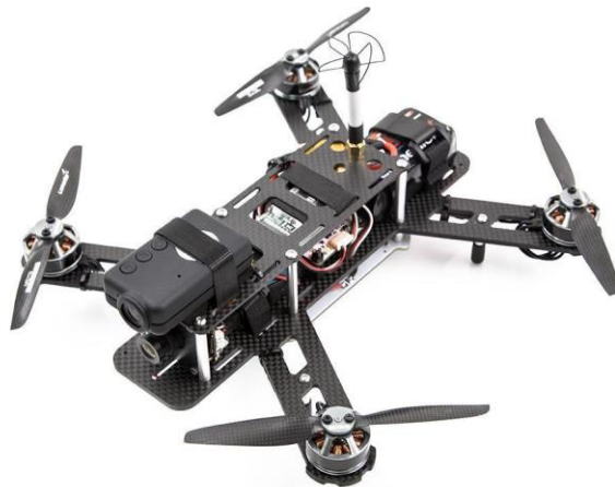
Kuva 4. QAV 250-kilpakopteri. (FliteFPV n.d)
