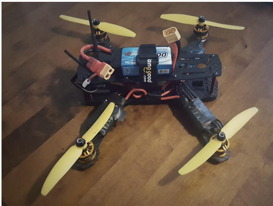
Kuva 18. Nelikopterin valmis testiversio.
