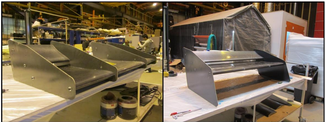
Kuva 63. Päätylevyn asennettuna paikoilleen.
