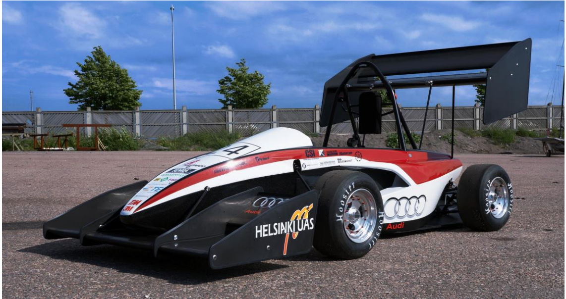
Kuva 69. Aerodynamiikkapaketti asennettuna HPF014E-kilpa-autoon.
