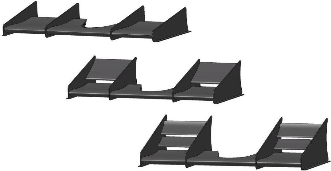
Kuva 13. HPF014E-auton 1-, 2- ja 3-elementtiset etusiipihahmotelmat.
