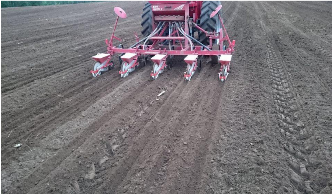
Kuva 3. Maissin kylvöä itse rakennetulla kylvökoneella. (Kuva: Kari Siitarinen, 2016)
