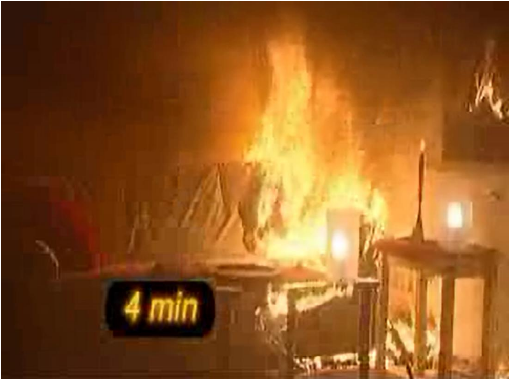
Kuva 2. Kuvakaappaus palonkehitysvideosta neljän minuutin kuluttua syttymisestä. Savukaasut ja lämpötila tekevät huoneesta hengenvaarallisen. Lähde: www.spek.fi .
