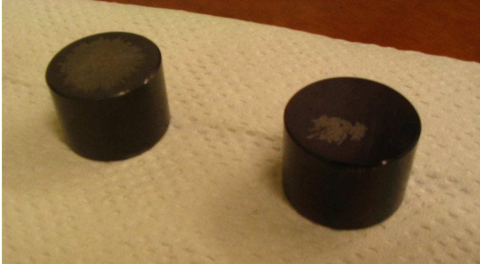
Kuva 11. Mittauksissa vaurioituneet timanttipinnoitetut venttiilinnostajat
