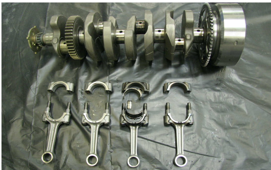
Kuva 4. 2007 Englannin kisassa sattuneesta voiteluhäiriöstä johtuvat vauriot. Kolmannen sylinterin kiertokanki ja kampiakselin laakeripinta selvästi tummuneet
