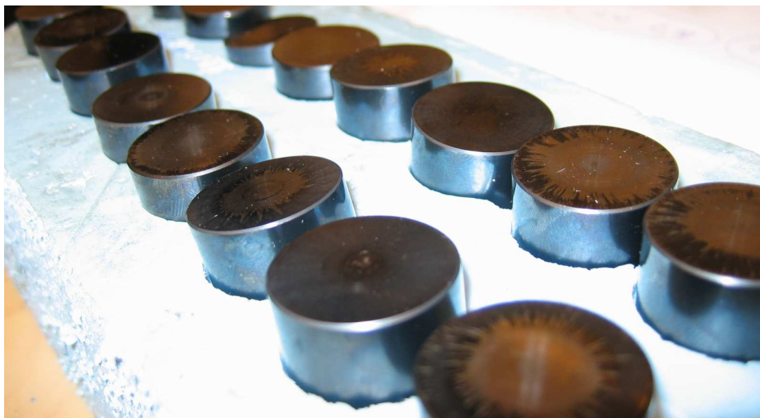
Kuva 3. HPF007-autossa testatut, pinnoitetut venttiilinnostimet, joissa pinnoite on vaurioitunut käytössä
