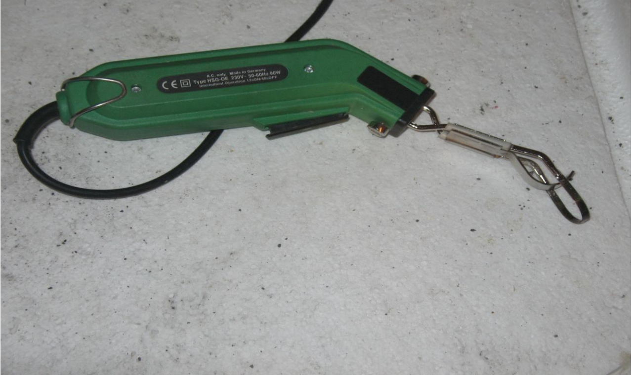
Kuva 2. Työkalu, jolla koverretaan polystyreeniin ura putkea varten.
