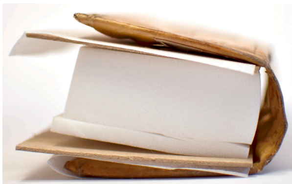
Kuva 31. Pergamenttia ollaan asettamassa muottiinsa kosteuskammion jälkeen.
