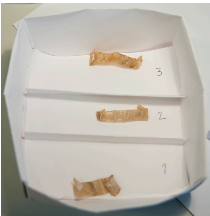
Kuva 34. Tässä arkistoaperista rakennetussa laatikossa tukinauhat menivät kosteuskammioon ja sen jälkeen painon alle.
