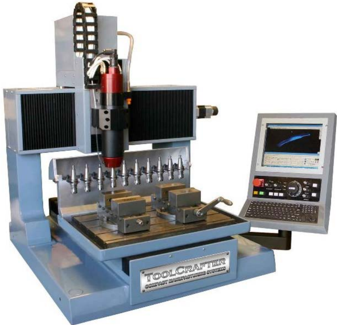
Kuva 4. CNC kiinteällä ristikkopalkilla (Black R.)
