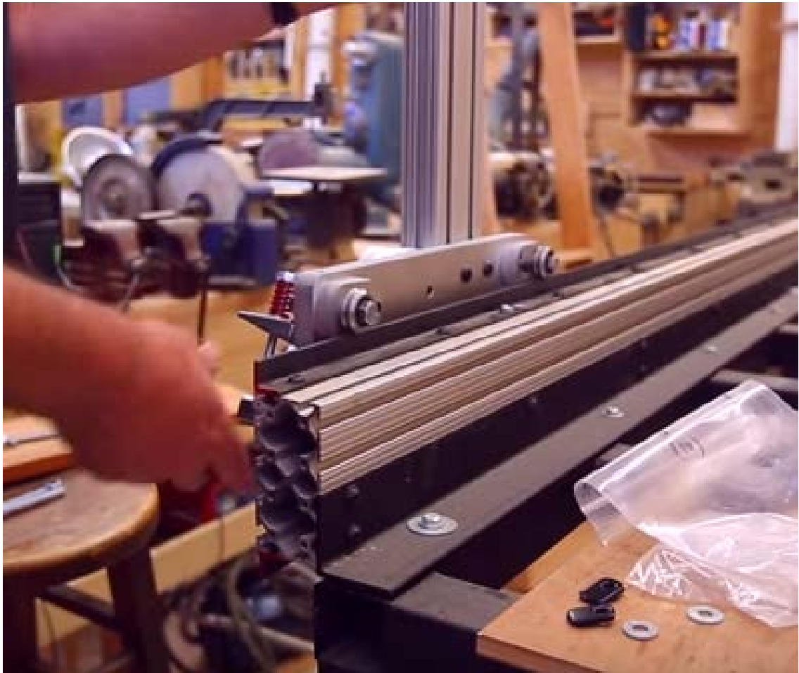
Kuva 7. V-urakuulalaakeri ja l-profiili johteena (Howarth, F.)
