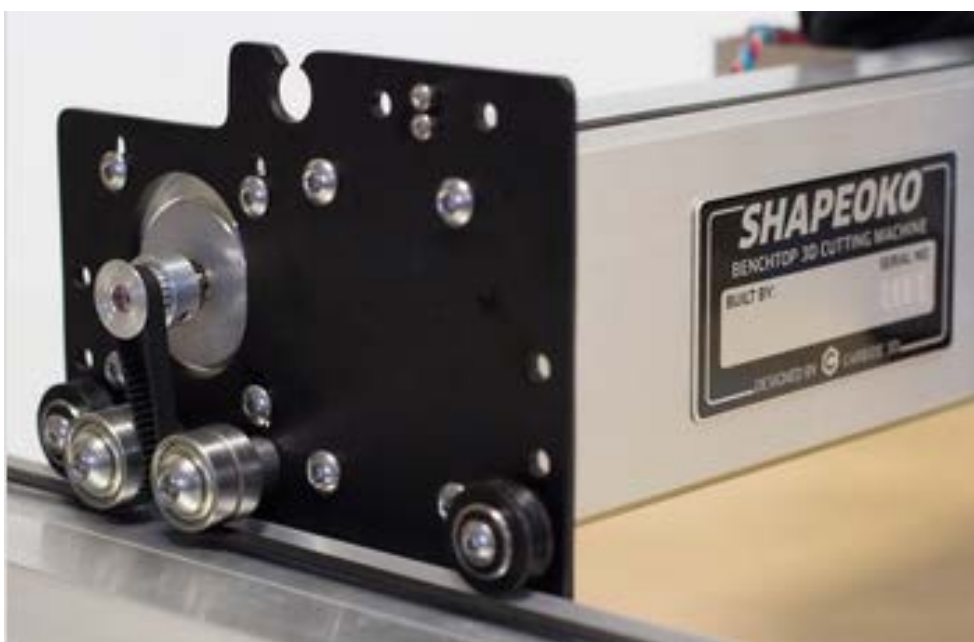
Kuva 5. Shapeoko hihnaveto (Carbide 3D)
