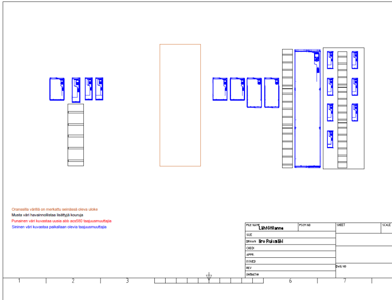
KUVA 16. Vanhojen Siemens Micromaster 440 -taajuusmuuttajien sijoitus sähkötilan seinälle
