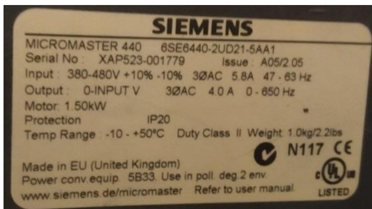
KUVA 10. Siemens Micromaster 440 -taajuusmuuttajan kilpitaulukko
