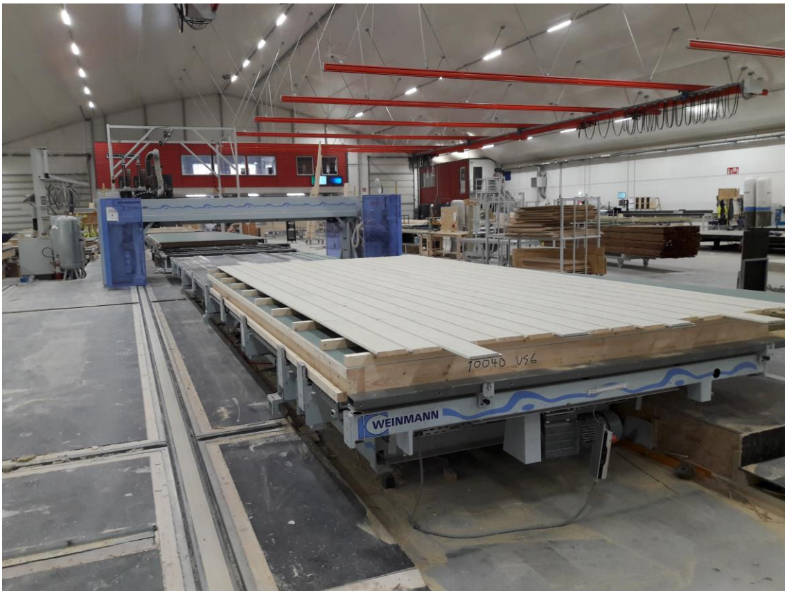
KUVA 5. Ulkoverhouksen asennus käynnissä panelointipöydällä.
