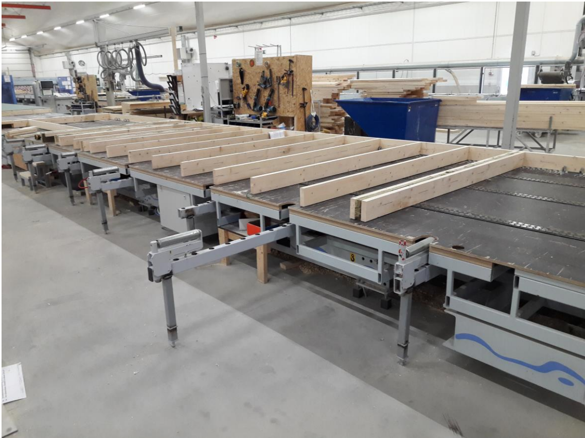
KUVA 3. Elementin rungon valmistusta runkopöydällä
