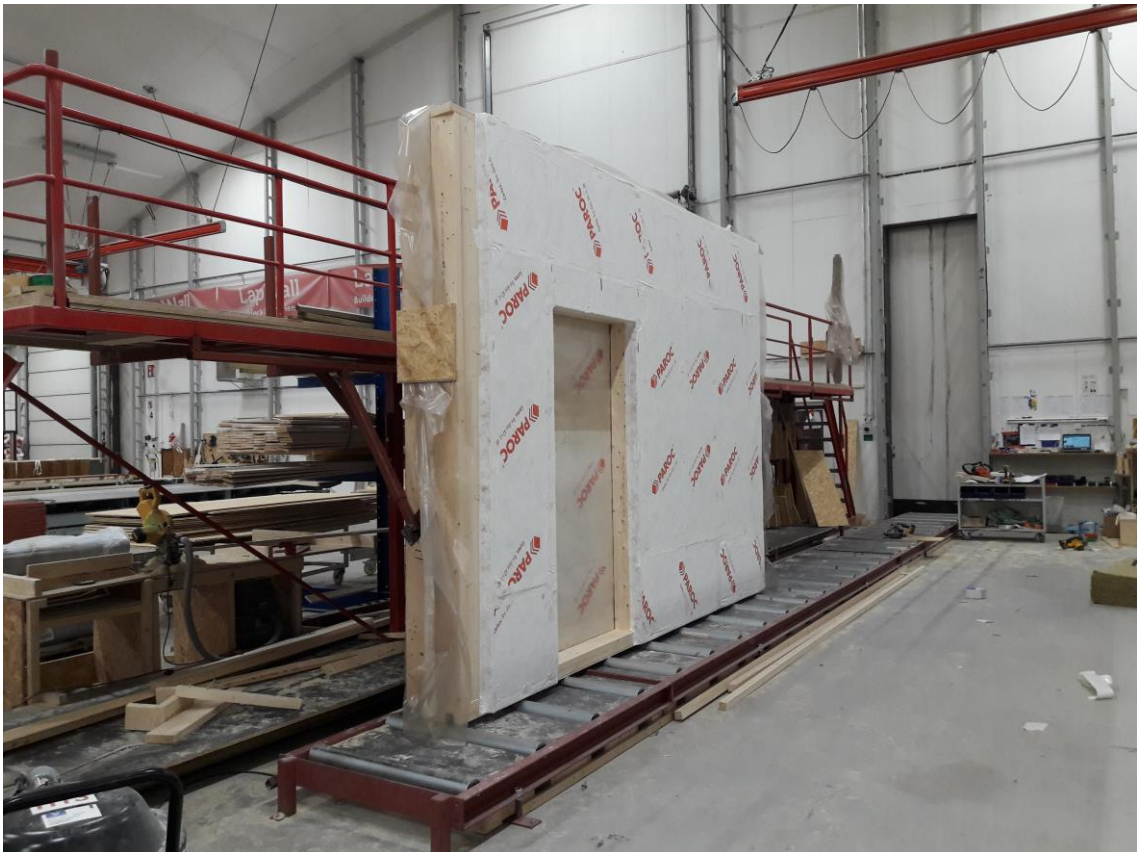
KUVA 8. Valmiit elementit pakentointipisteen rullaradalla.
