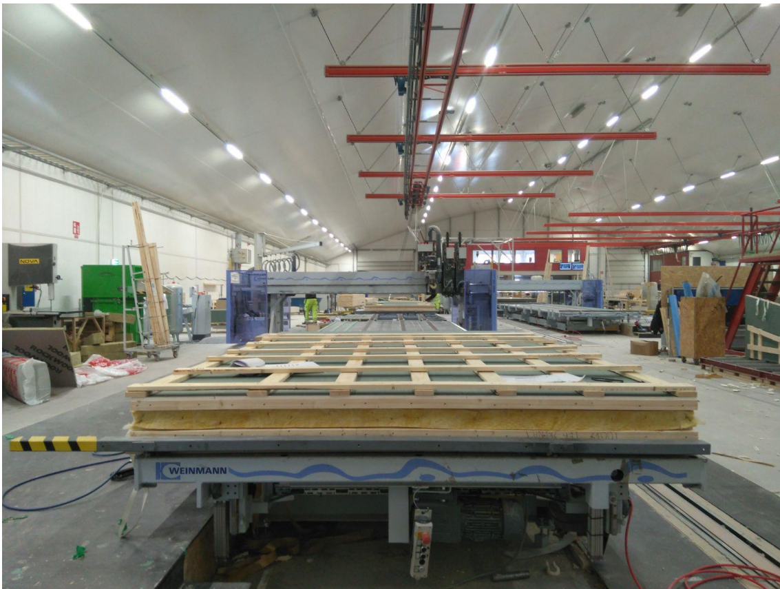
KUVA 7. Koolauksien asentaminen viitospöydällä käynnissä.
