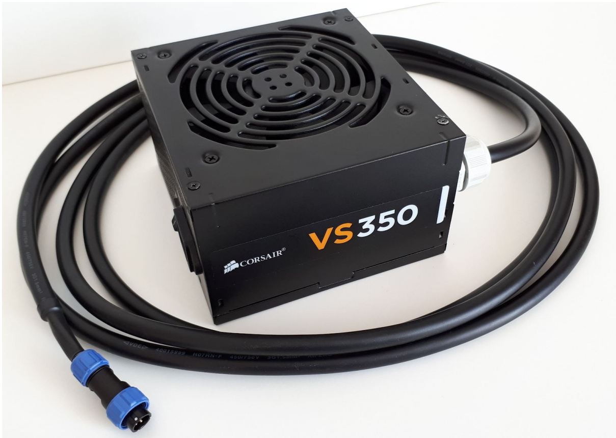
Figur 19. Modifierat Corsair VS 350 nättaggregat.
