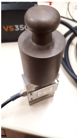
Figur 16. 1 kg precisions vikt för kalibrering av givaren.
