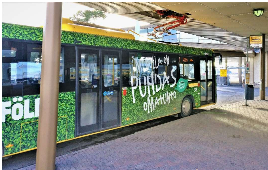
Kuva 2. Virroitin laskeutumassa bussin katolle sataman pikalatausasemalla.
