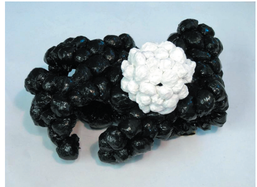
Kuva 16 Muovipussipallerokokeilu, jossa valkoinen osa on sulatettu
