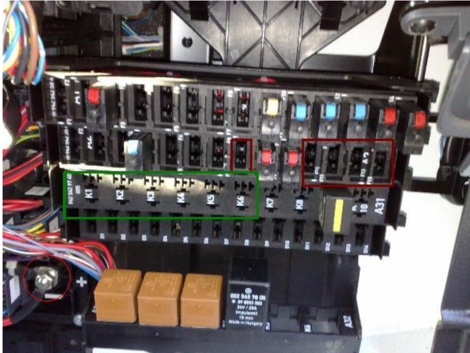
Kuva 2. Sulakkeiden ja releiden sijoitus
