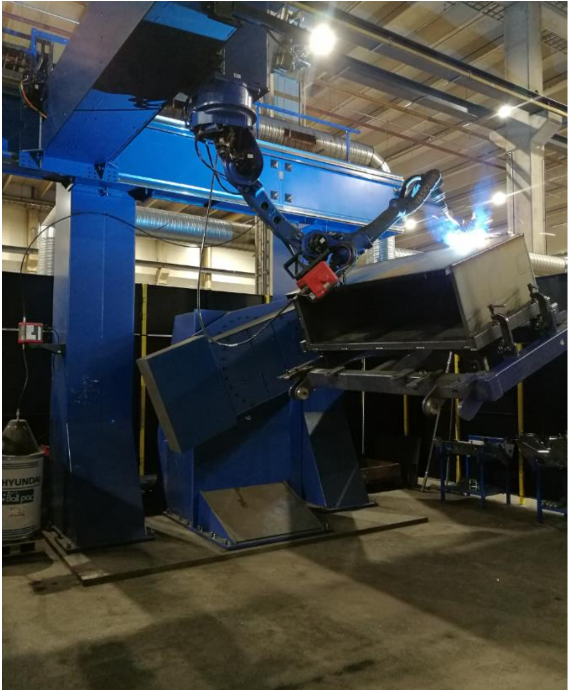
Kuva 8. Laitteisto kokonaisuudessaan. Kuvassa hitsattavana on CombiMax puristimen mäntä.
