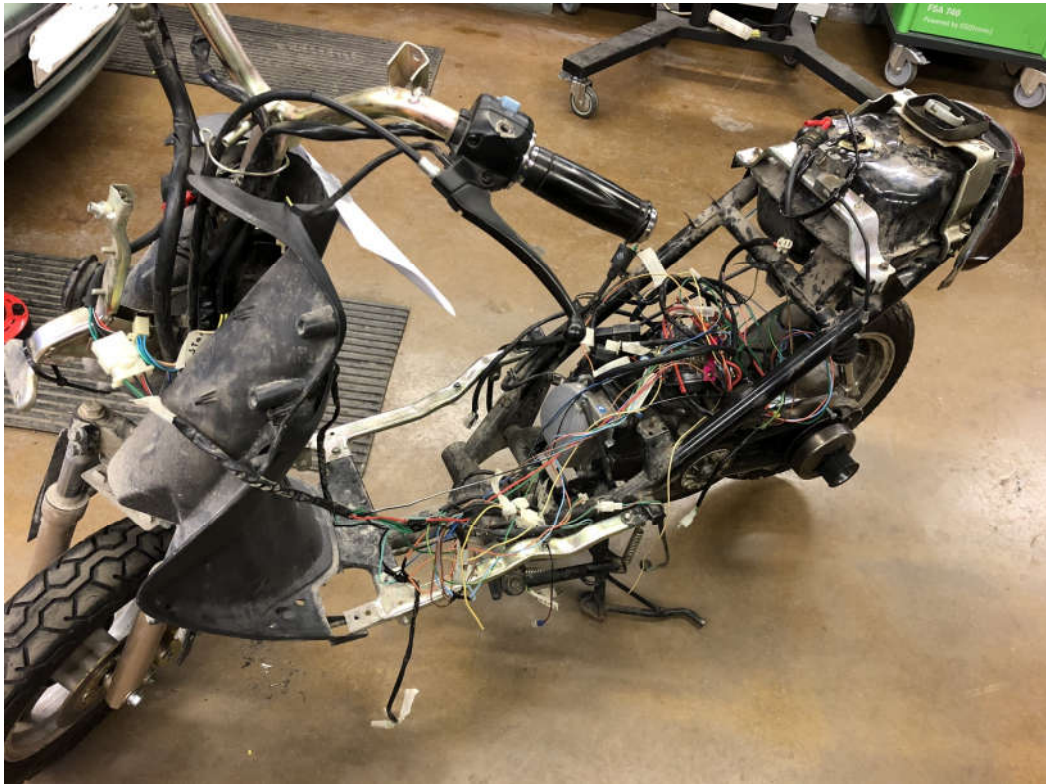
Kuva 1. Katteista riisuttu ja johtosarjalta karsittu runko.
