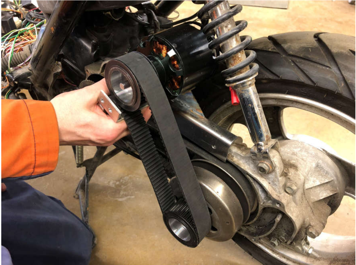
Kuva 2. Moottorin sijoitus sekä hihnavoimansiirto kytkimen päätyakseliin.
