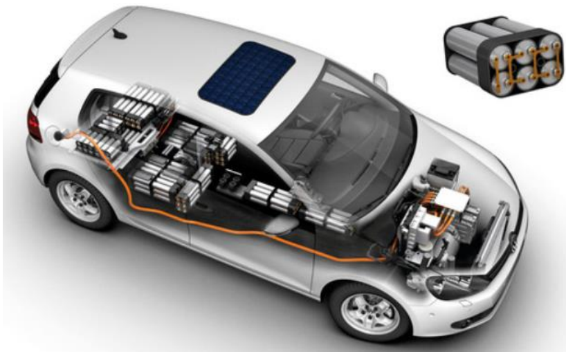
Kuva 5. Akuston sijoituspaikkoja läpileikkauskuvassa.
