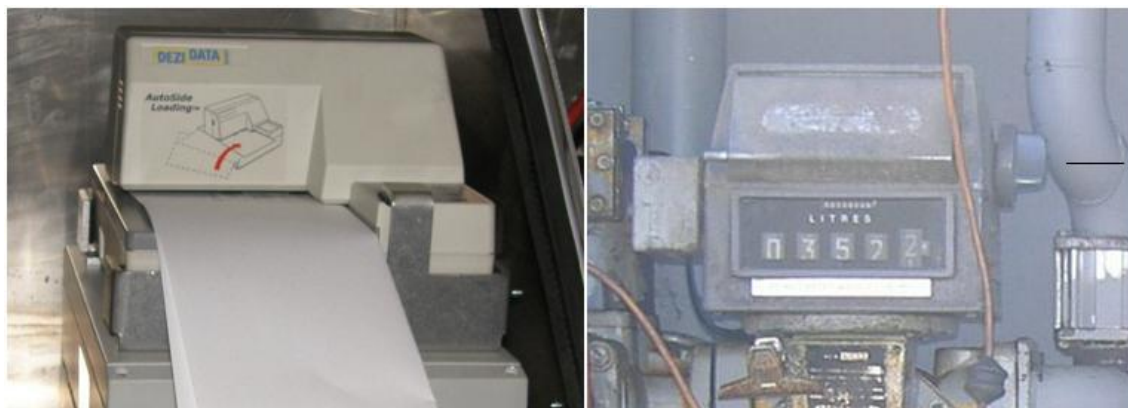
Kuvio 10: Mekaaninen ja elektroninen kuittitulostin (kuva K.P. Säiliöt Ay)
