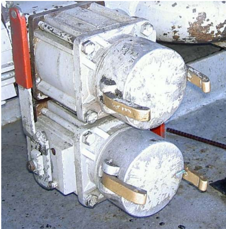
Kuvio 11: Kahvalla avattava palloventtiili (kuva K.P. Säiliöt Ay)
