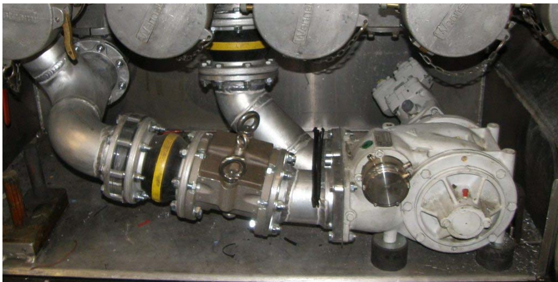
Kuvio 6: Alfons Haar-tuotepumppu vetoautosäiliön kaapissa (kuva K.P. Säiliöt Ay)
