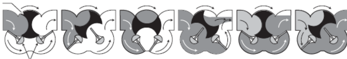
Kuvio 12: Tilavuusmittarin roottoreiden toimintaperiaate /12, s. 6/
