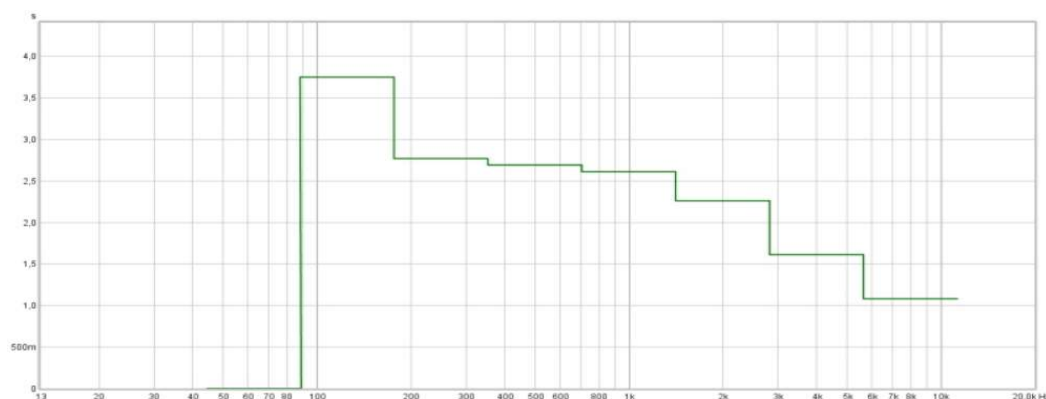
Kuva 9. Jälkikaiunta-ajan lähtötilanne ennen mitatun tilan akustointia. Kuvassa noin 90 Hz taajuuksilla jälkikaiunta-aika on lähes 4 sekuntia. (Kaj Enberg)
