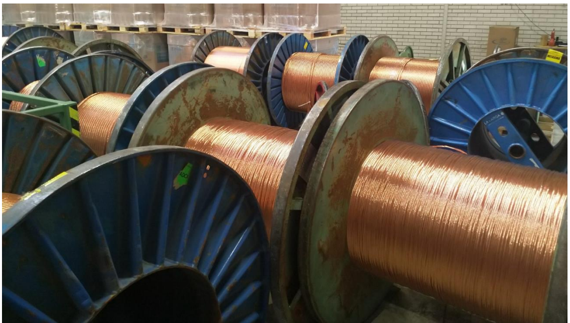
Kuva 12. Kupariköysikelojen varastointi irrallaan lattialla
