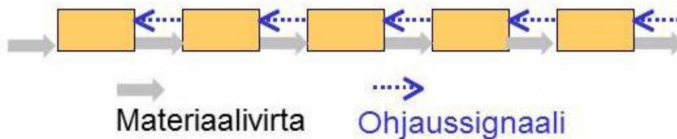
Kuva 2. Imuohjauksen toteutuminen (Logistiikan maailma 2018d)
