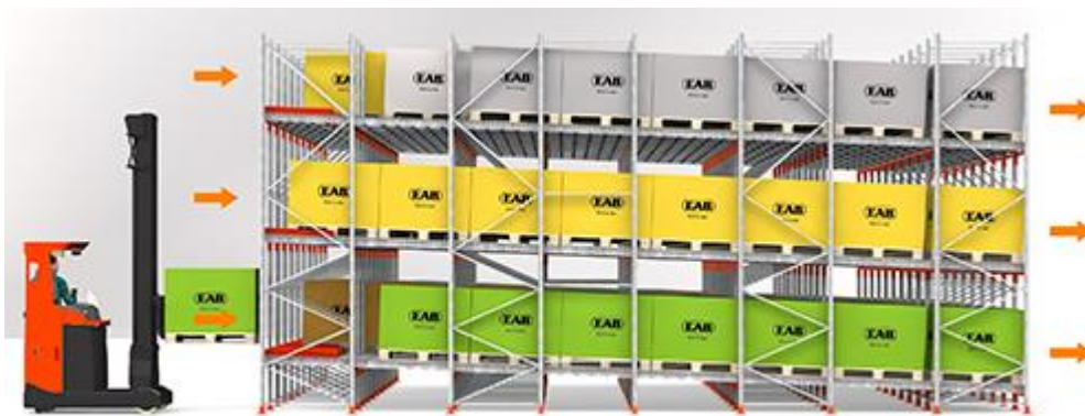
Kuva 8. Läpivirtaushyllyn toimintaperiaate (EAB 2018)
