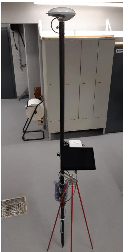
Kuva 10. Tarkkeiden mittaukseen sopiva, anroid-tabletilla varustettu GNSS-sauva (Eija Mertanen)
