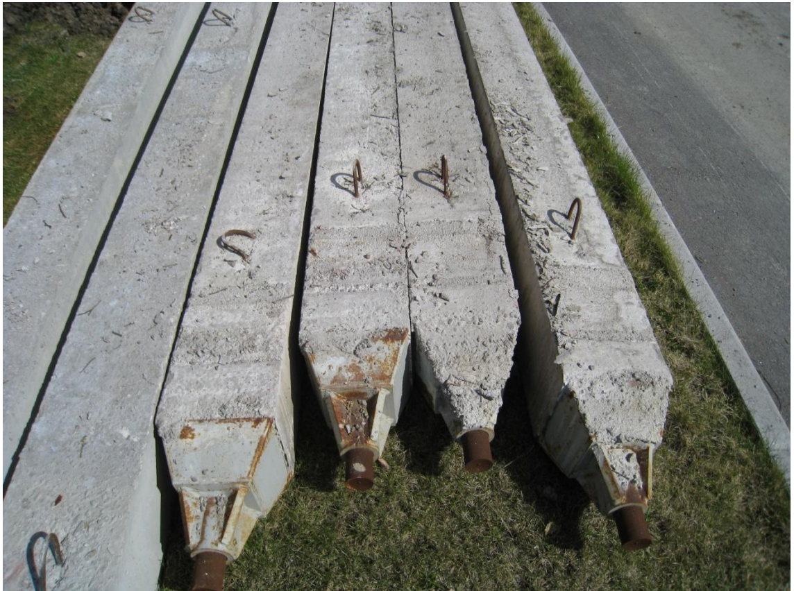
Kuva 12. Kalliokärjellisiä teräsbetonipaaluja (300x300mm)
