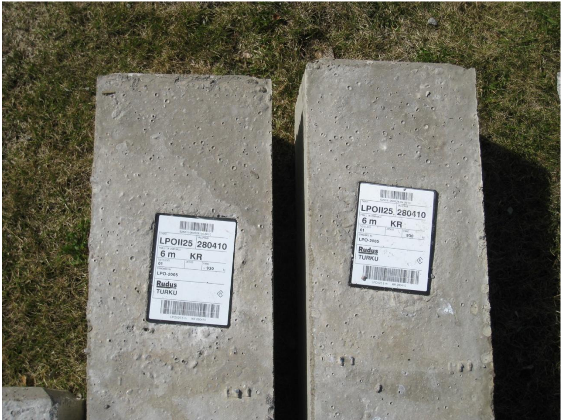
Kuva 13. Teräsbetonipaalun valmistustietolappu (Rudus 2010)
