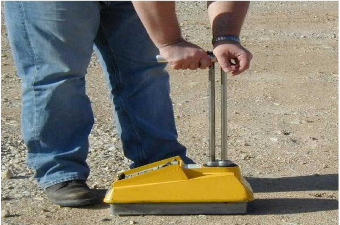
Kuva 12 Troxler mittaus (Rakennuskone 2018b)
