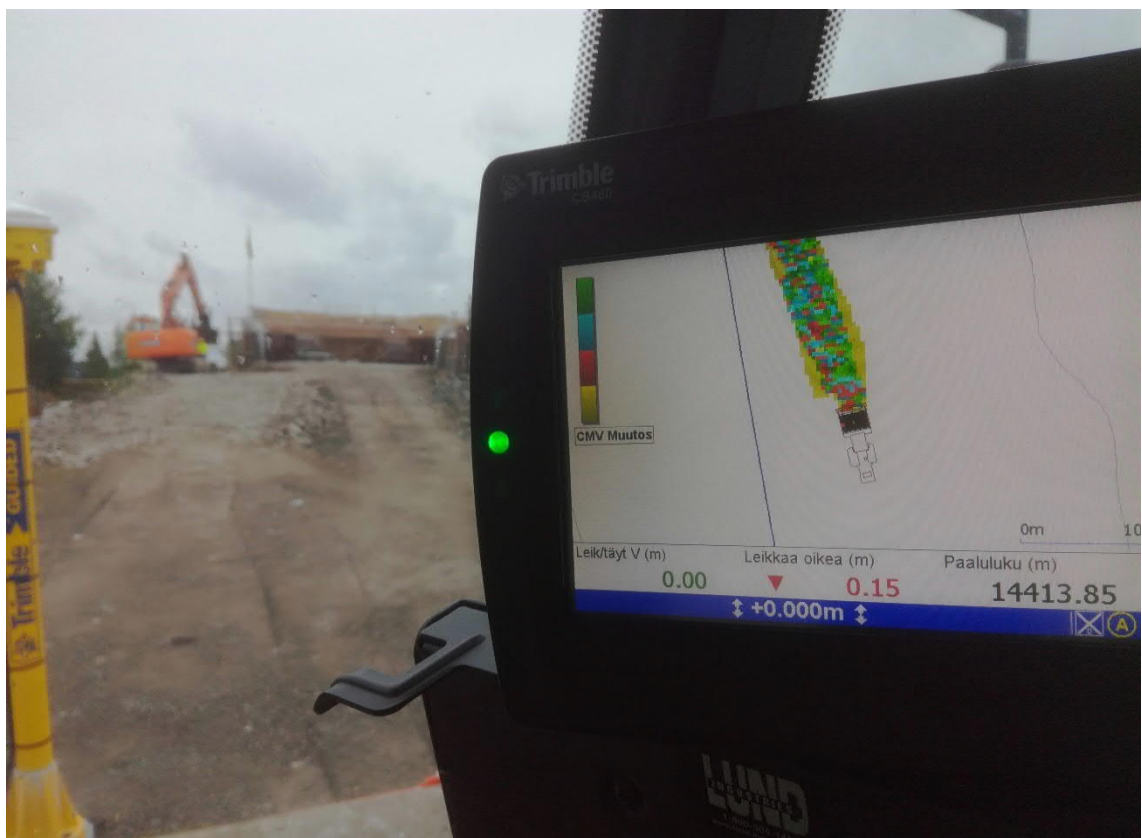
Kuva 9 Jyrän kuljettajan näkymä. Näytöllä CMV-arvon muutos.
