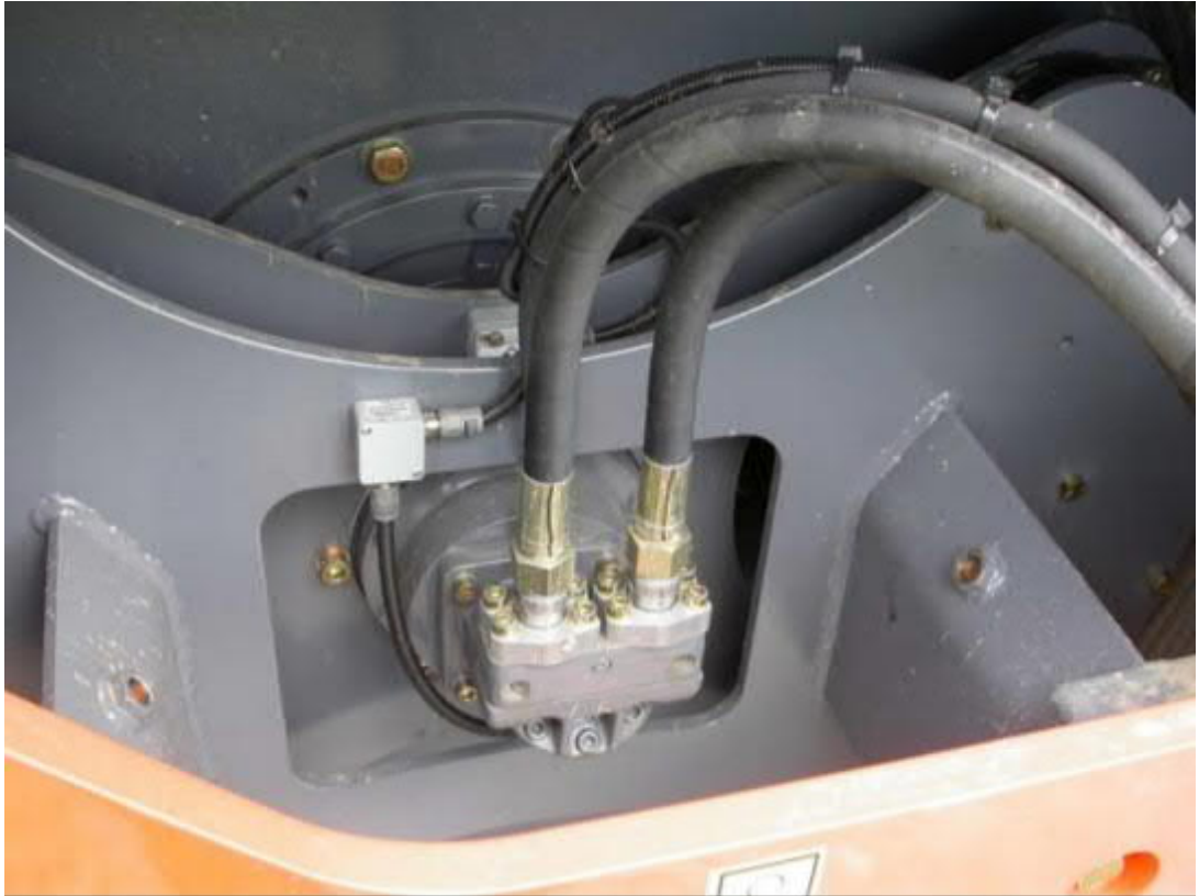
Kuva 4 Kiihtyvyyssanturi valssijyrään kiinnitettynä (Laukkanen, Halonen & Pyy 2012)
