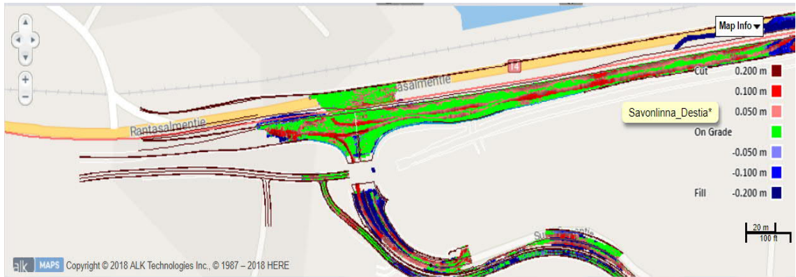
Kuva 8 Leikkaa/täytä näkymä kuvastaa toteutuneen pinnan eroa suunnitellun mukaiseen pintaan
