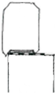
Kuva 24. Bitumihuovan paikka perustuksen päällä [23.]
